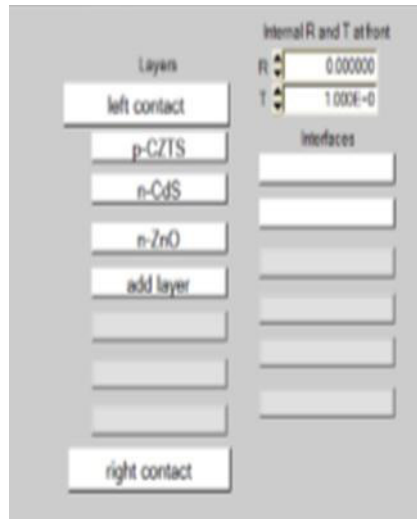
Figure III. 4 : Définition de la structure d'une cellule solaire.
