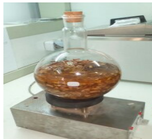
Figure III.3 : fibres traitées par silane
