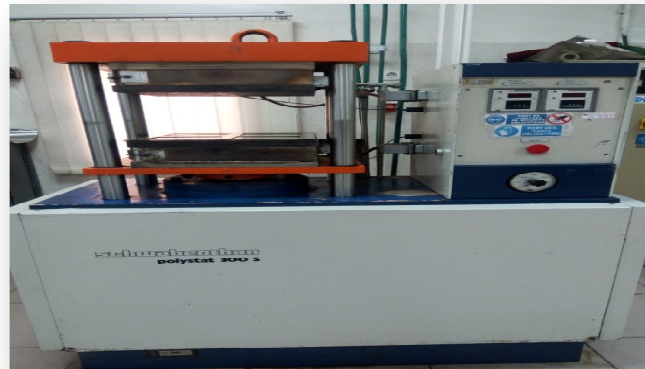
Figure III.7 : presse hydraulique de type Schwaben han polystat 300 S
