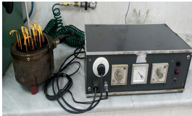
Figure III.24: Essai de la stabilité thermique.
