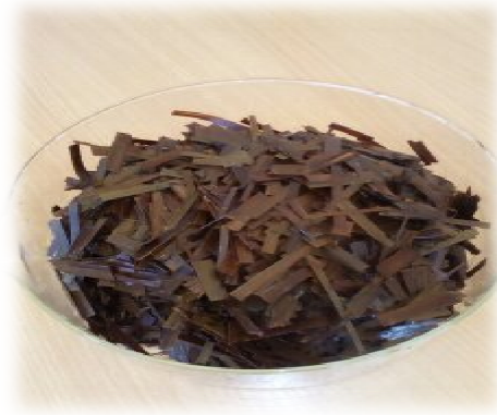
Figure III.2 : fibres traitées par NaOH
