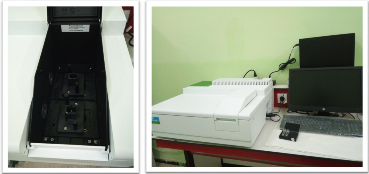
الشكل II.17: مطياف UV-Vis (PerkinElmer-Lambda25).
