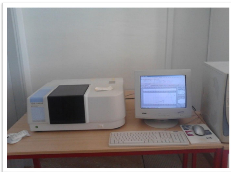
الشكل II.18: مطياف الأشعة تحت الحمراء (FTIR-8400s).
