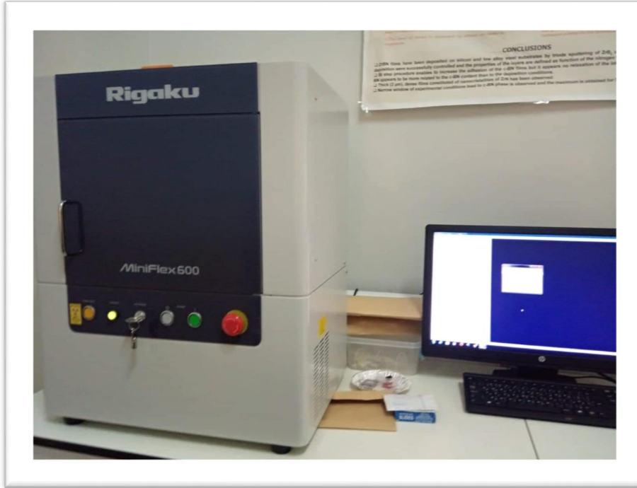
الشكل II.14: صورة لجهاز انعراج الأشعة السينية (XRD).
