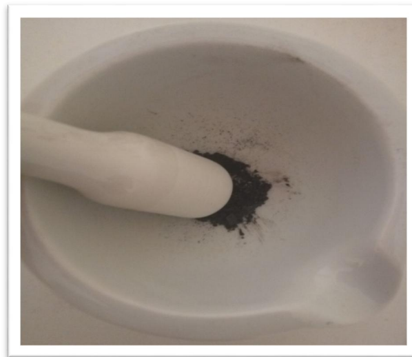
الشكل II.8: توضيح سحق CuO.
