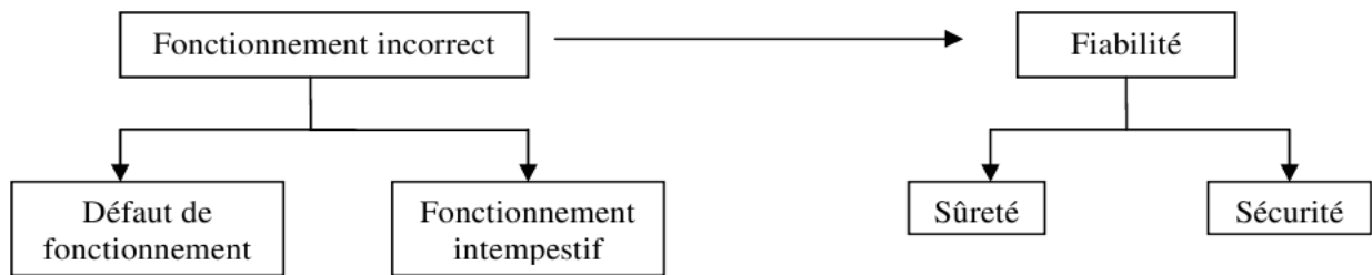
Figure .II.19. Fiabilité d'une protection [23]
