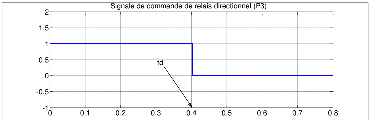
FigIII.70. Signal de commande du relais directionnel (P3)
