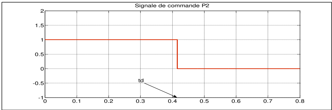
Fig.III.46. Signale de commande la protection directionnelle P2
