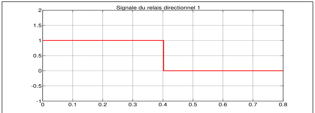
Fig.III.54. Signal de commande généré par le relais dir de la protection P4
