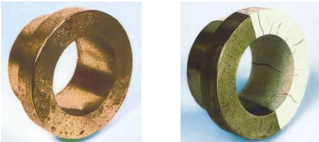
Figure I.2 : Exemple d' une pièce avant (à gauche) et après (à droite) le contrôle par ressuage.
