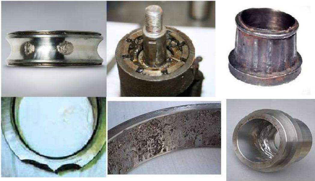
Fig I.10 Principaux Défauts Sur Le Roulement.[2]
