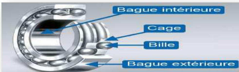
Fig I.1 Des Eléments Constitutifs D'un Roulement[1].
