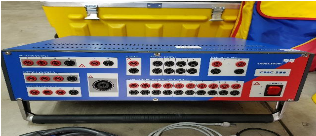
Fig.III.4 : Caisse d'injection omicron cmc356 : source GRTE.
