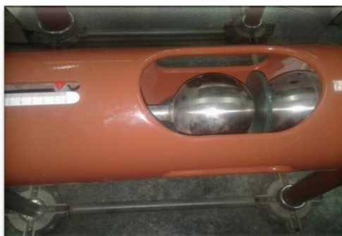
Figure V.7 : l'isolant est leur épaisseur entre les deux électrodes.
