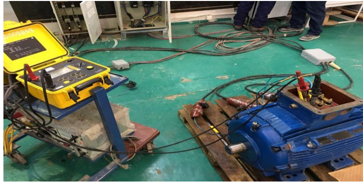
Figure III.11 Mesure des résistances entre bobine avec micro- ohmmètre.
