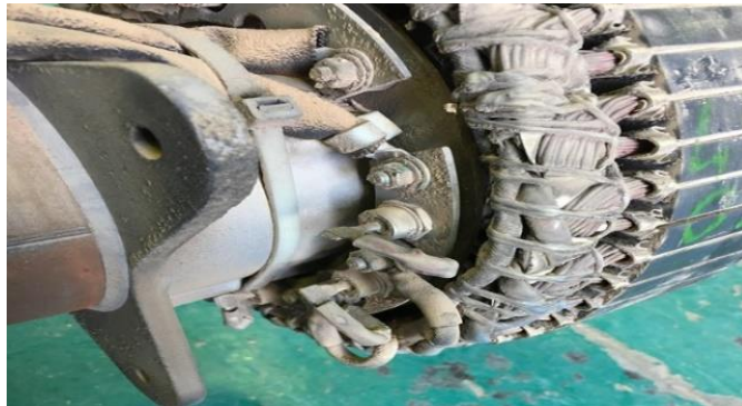
Figure III.40 Pont diodes de l'alternateur.
