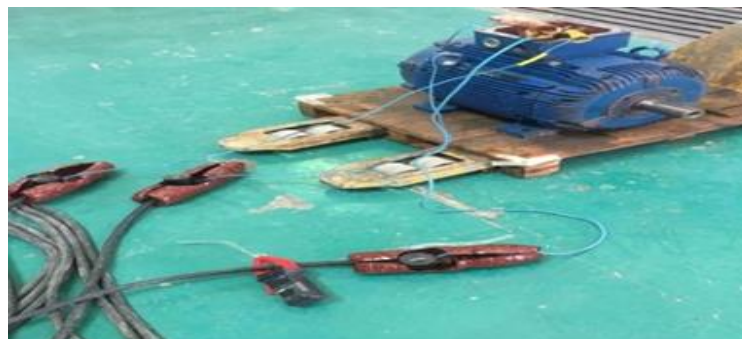
Figure III.20 Essai    vide du moteur.
