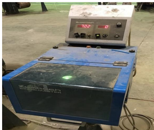
Figure II.20 Testeur des défauts « zumbach ».
