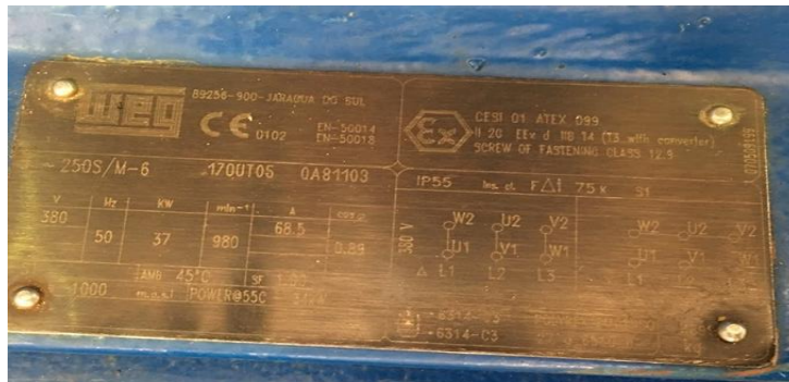
Figure III.2 Schéma de plaque signalétique du moteur asynchrone triphasé.
