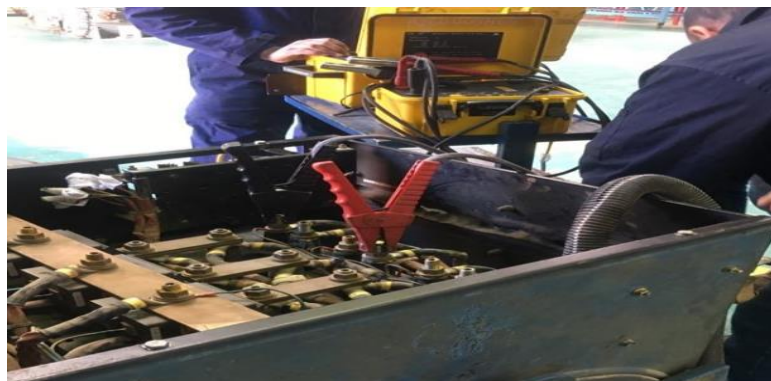
Figure III.36 Mesure de résistance d'isolation du stator.
