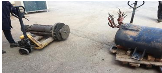
Figure III.46 Nettoyage de l'alternateur de la poussière.
