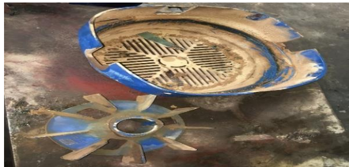
Figure III.8 Ventilateur et capot de ventilation.
