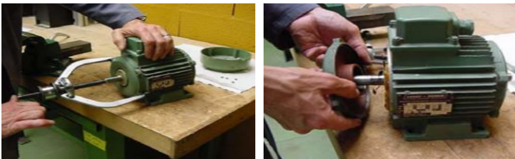
Figure III.13 Démontage du flasque côté poulie. [15]
