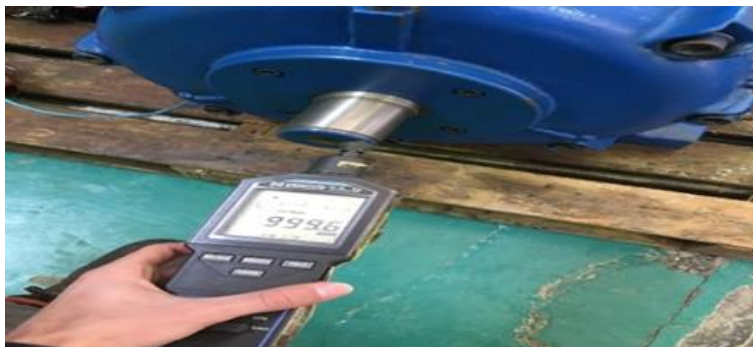
Figure III.22 Mesure de la vitesse de rotation avec un Tachymètre.
