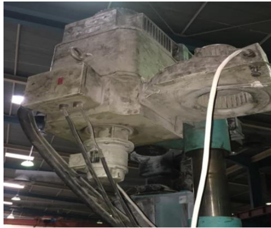
Figure II.10 Moteur asynchrone de positionnement vertical.
