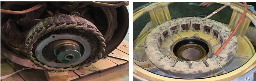
Figure III.33 L'induit et l'inducteur de l'excitatrice.
