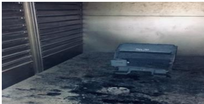
Figure III.17 Séchage du moteur dans le four.
