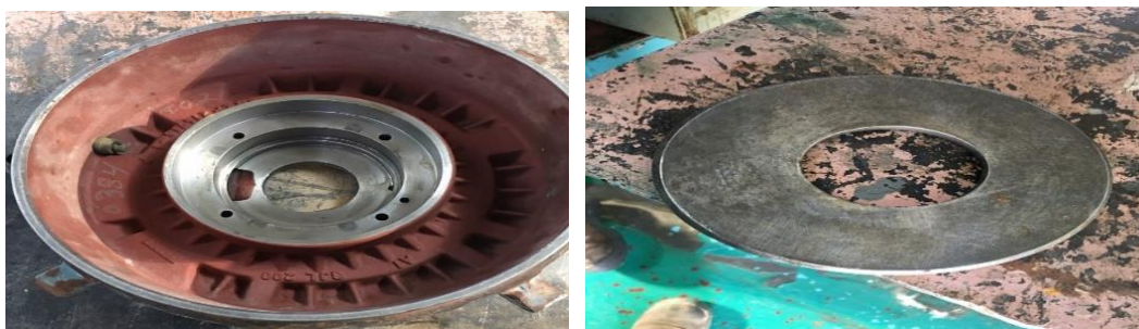
Figure III.6 Flasque et contre flasque du moteur asynchrone.
