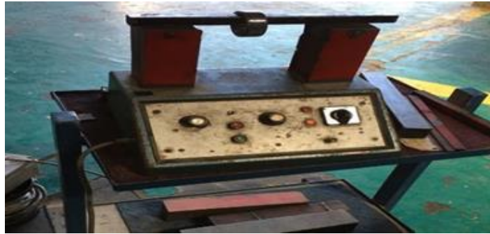
Figure III.18 Echauffement du roulement par induction.
