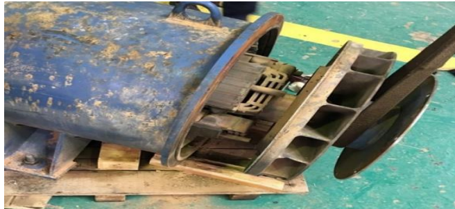
Figure III.45 Extraction de la roue polaire du stator.
