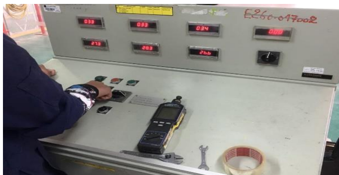
Figure III.55 Source de tension variable sinusoïdale de 50 Hz.
