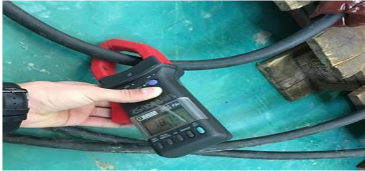
Figure III.21 Mesure du courant avec une pince ampérométrique.
