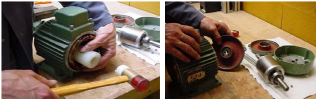
Figure III.15 Démontage du flasque coté ventilateur. [15]
