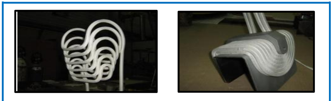
Figure I. 7: Inducteur enveloppant en cours de fabrication (Fives Celes)
