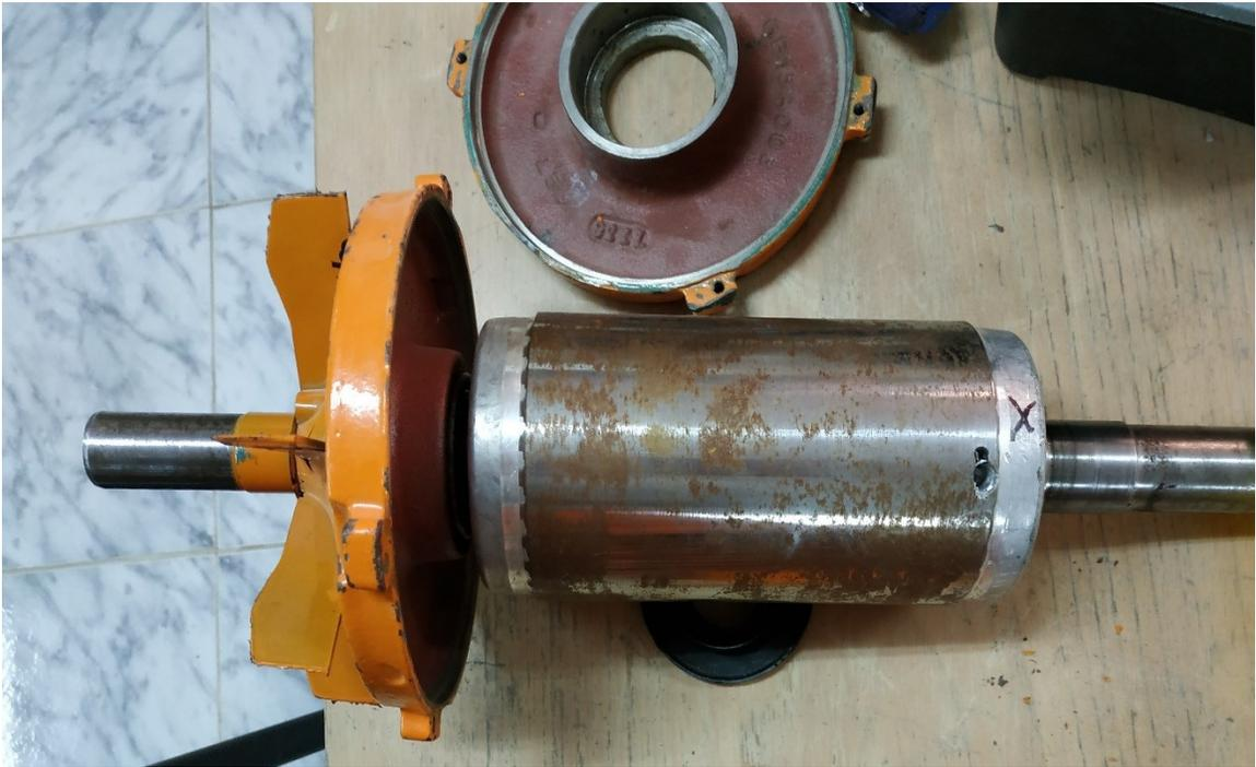
Figure III.6. Rotor utiliser dans la cassure de barre
