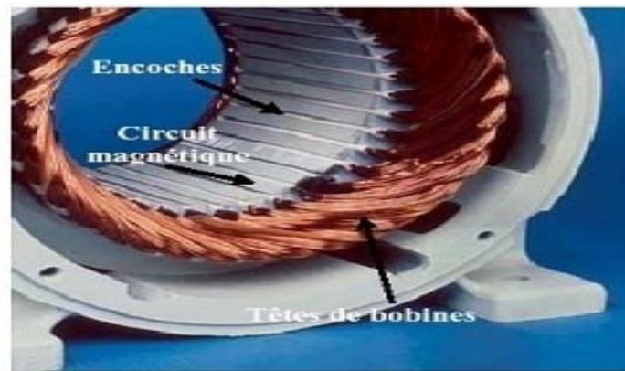
**Fig. I.3.** Photo du stator d'une machine asynchrone[1].
