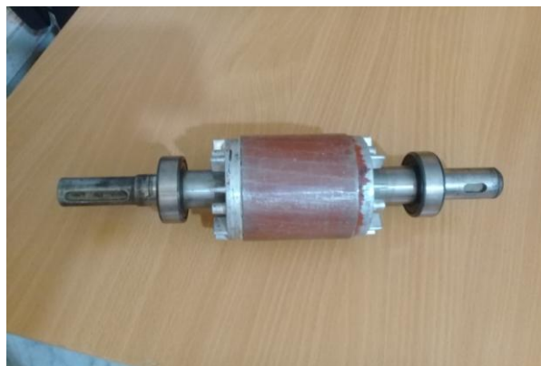
Figure I-3 : Le rotor à cage AZAZGA
