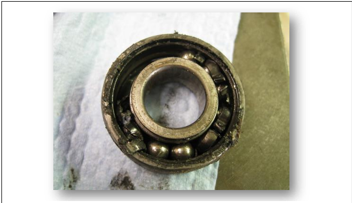
Figure I.13 Vue de roulement défectueuse (billes écorchées) [25].
