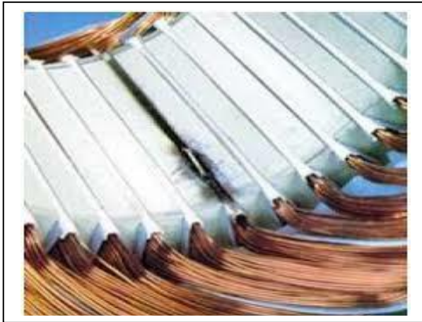
Figure I.10 Défaillance entre spire [21].
