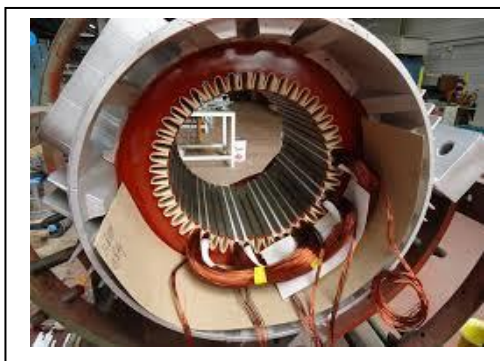
Figure I.3 Stator du moteur asynchrone [9]. Figure I.4 Stator en cours de bobinage [10].
