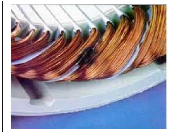
Figure I.11 Défaillance entre enroulement [22].
