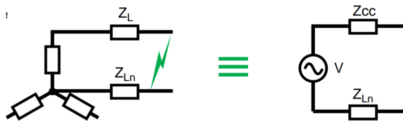
Fig. I.13 : Court-circuit monophasé isolé
