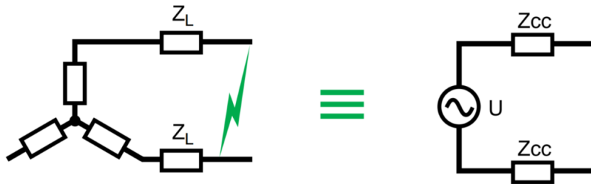
Fig. I.12 : Court-circuit biphasé isolé
