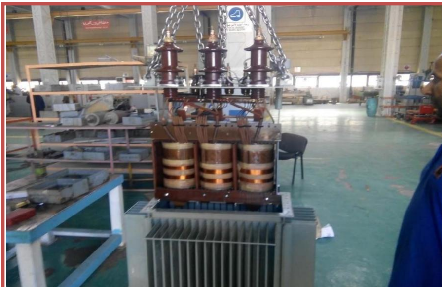
Fig. III.7 : Décuage et levage de la partie active du transformateur
