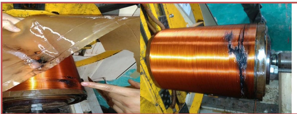
Figure III.15 : Ces photos montrent le défaut réel indiqué sur le bobinage HT.
