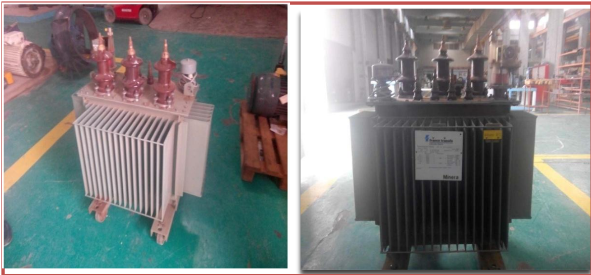
Fi. III.2 : Transformateur de distribution MT/BT 100KVA
