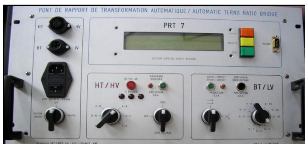
Fig. III.5 : Pont de mesure de rapport du transformateur (testeur de rapport du transformateur)
