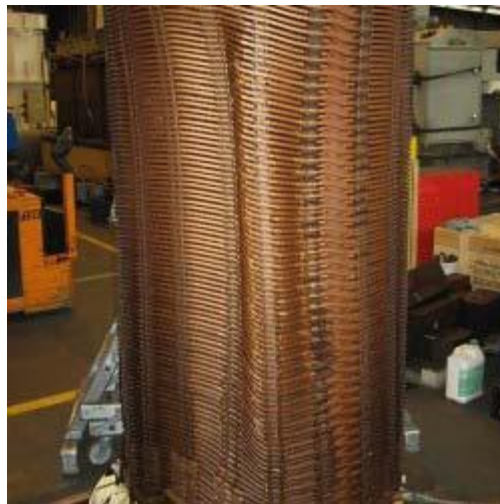
Fig. II.10 : Défaut de type électrodynamique
