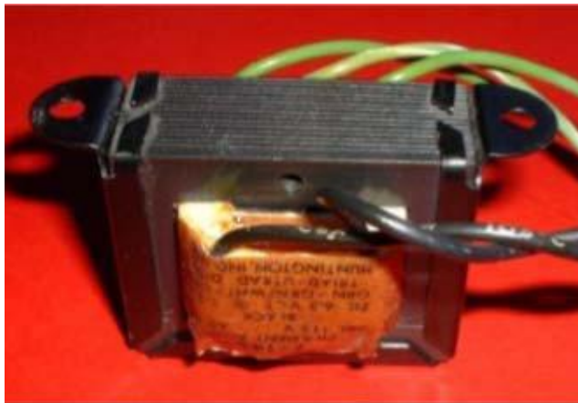
Fig. I.29 : Transformateur à noyau feuilleté. Le haut des feuilles est visible sur la partie supérieure de l'unité.
