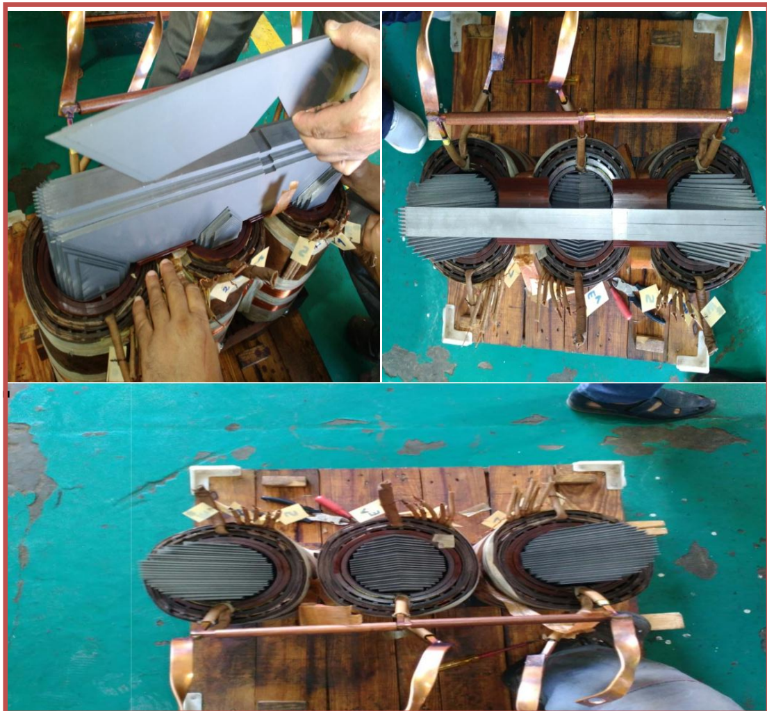
Fig. III.11 : désassemblage du circuit magnétique
