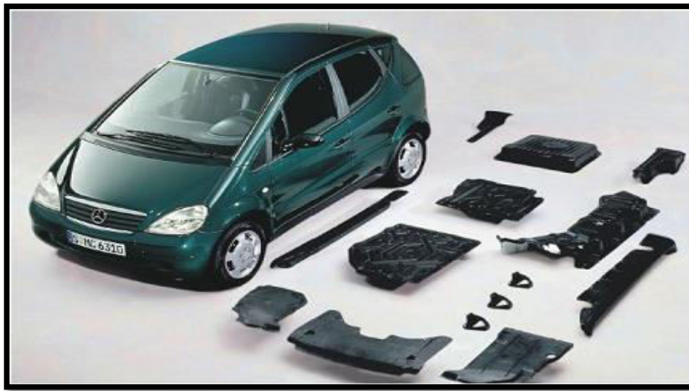
Figure I.9 : Pièces élaborées en matériaux composites à fibres végétales Mercedes Benz A-Class [SAL-16].
