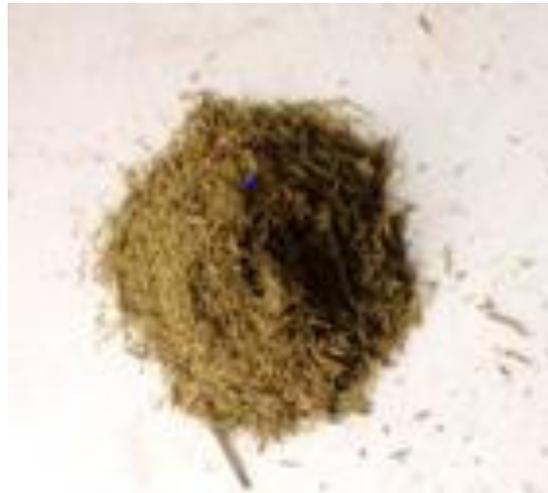
**Figure II. 11:** Fibre des feuilletes utilisées comme renfort.
