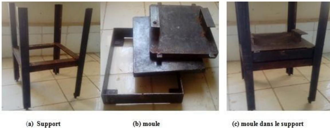
**Figure II. 1:** Moule métallique démontable.
