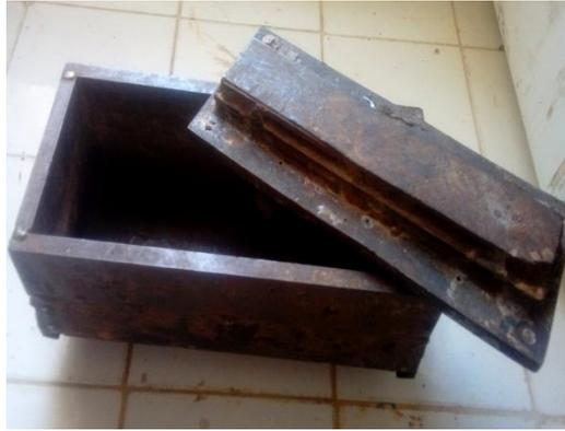
**Figure II. 7:** Le moule Métallique.
