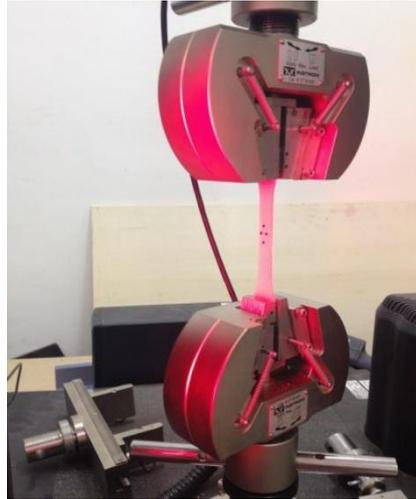
Figure II. 14: Epreuve dans la machine de traction.
