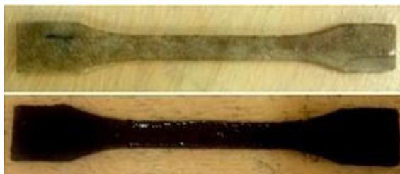
**Figure II. 6 :** Epreuve d'essai de traction : (a) Originale, (b) Colorée.
