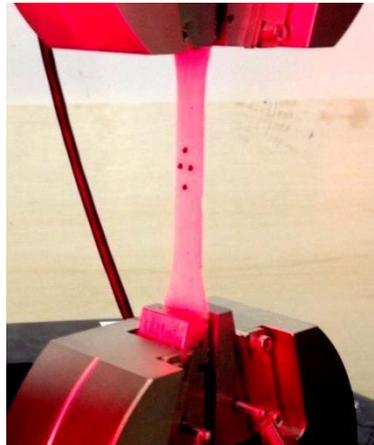
**Figure II. 18:** des éprouvettes avec le point de mesure de coefficient de Poisson.
