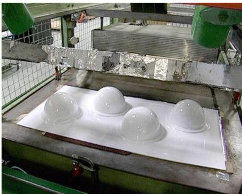
**Figure I. 9:** Procédé de thermoformage.
