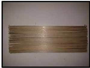
(a) : Fibres alignées dans un scotch adhésif
