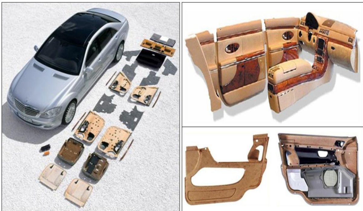
Figure (I.20) : Quelques applications de fibres naturelles dans le domaine de l'automobile [42].
