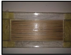
(b) : Les fibres alignées placées dans le moule
