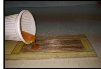
(c) : La résine est coulée sur la couche de fibres
