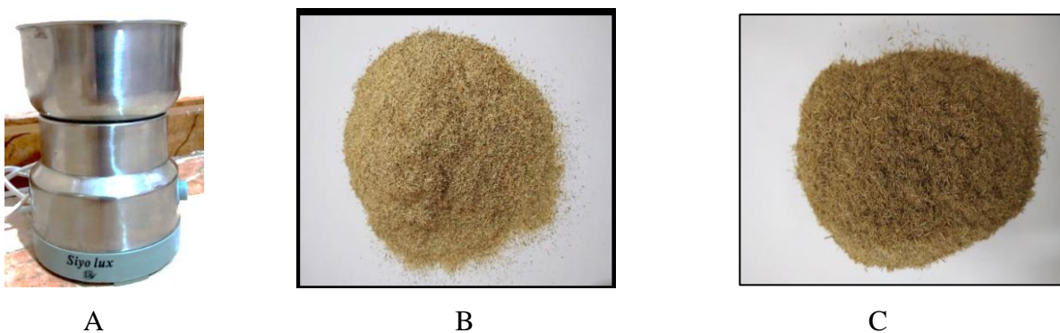
Figure (IV.2): Les fibres moulues, (A): la moulinette utilisée, (B) : fibres non traitées et (C) : Fibres traitées avec 05% NaOH pendant 48h.
