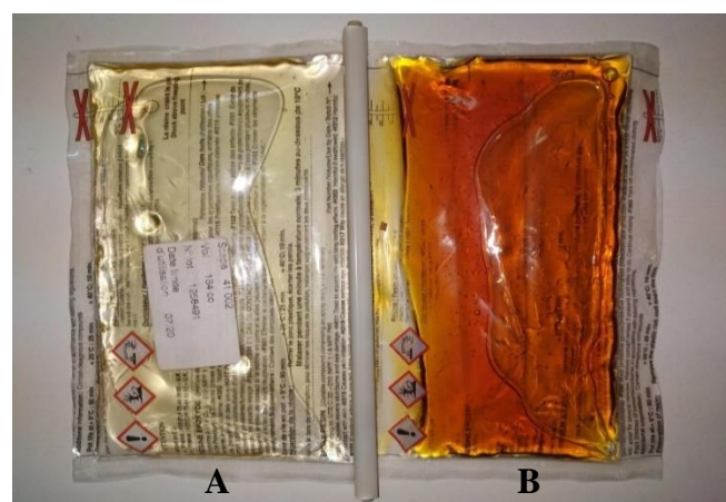
Figure (IV.6): La Résine de Marque Scapa 41, (A) : la résine scapa 41, (B) : le durcisseur.
