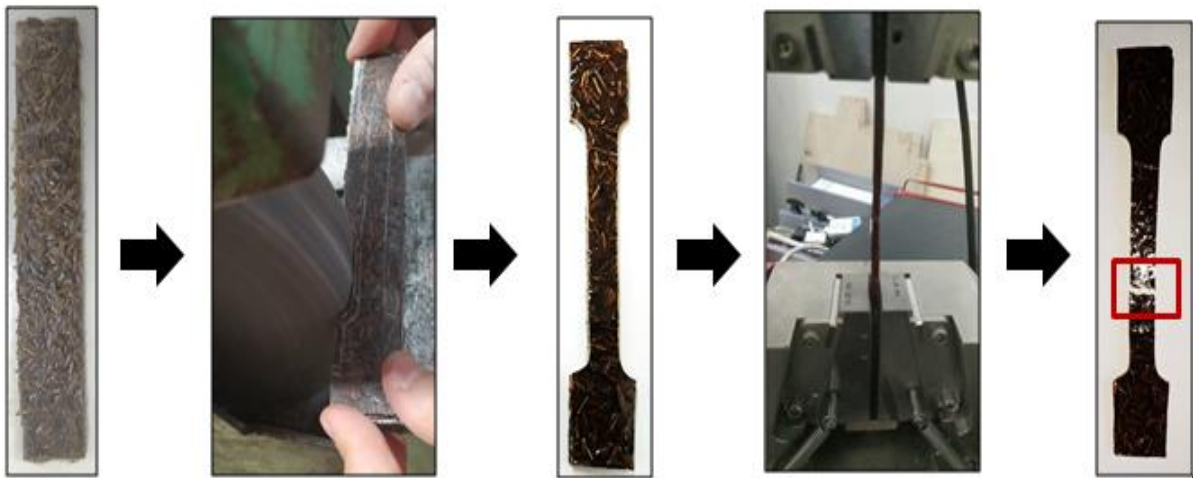
Figure (IV.9): Les étapes réalisées pour faire l'essai de traction.
