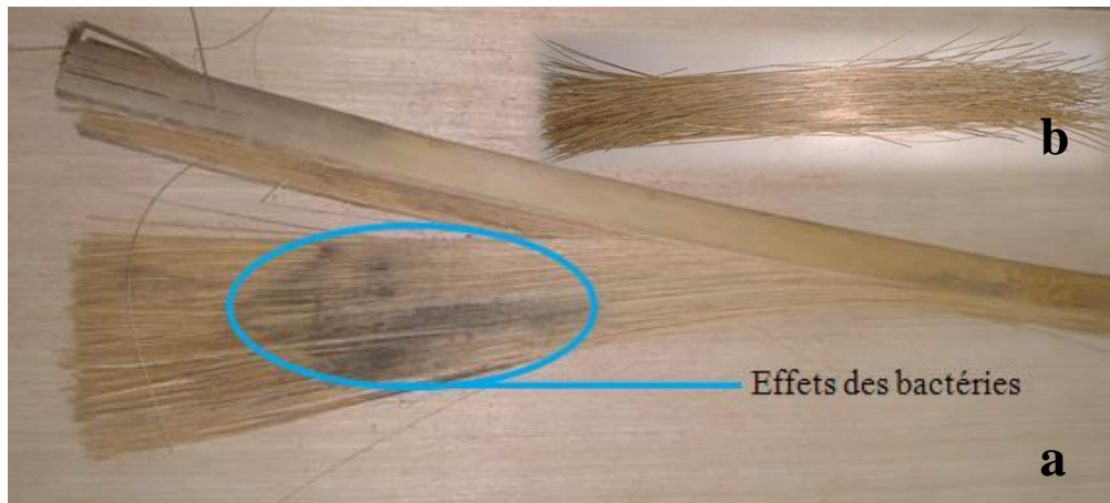
Figure (III.10): Les fibres extraites par la méthode biologique (rouissage à terre) a: avant le lavage et b: après le lavage à l'eau douce.
