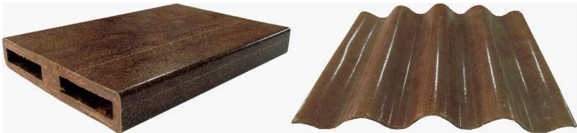
Figure (I.19) : Composites thermoplastiques renforcés avec les fibres de bambou [39].
