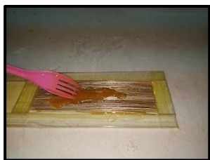
(d) : Distribution de résine sur tout la surface
