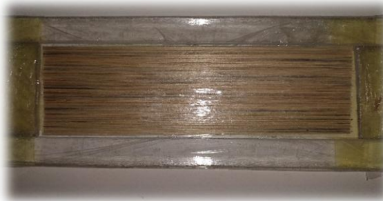
Figure (IV.10) : dépôts de la première couche de fibre dans le moule
