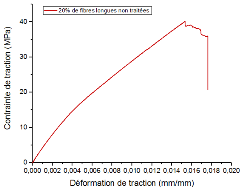
Figure (IV.15) : allure de la courbe de l'essai de traction de la résine + Fibre longue
