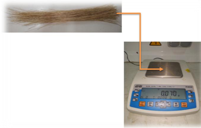
Figure (IV.8) : Pesage de fibre avec la balance électronique
