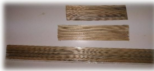
Figure (IV.9) : Disposition des fibres sur le ruban adhésif
