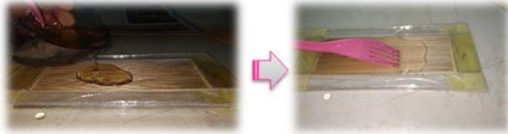
Figure (IV.11) : couler de la résine sur les fibres et l'étendre sur la couche de fibre.
