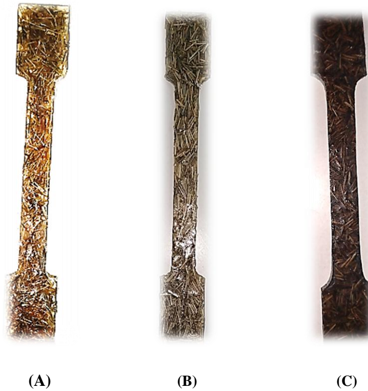
Figure (IV.18) : Les bio composites réalisées, (A) : à base de fibre traitées avec 2% de NaOH, (B) : à base de fibre courte non traitées, (c) : à base de fibres de life.
