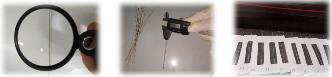
Figure (III-17) : préparation de l'Eprouvette de fibre pour l'essai de traction.
