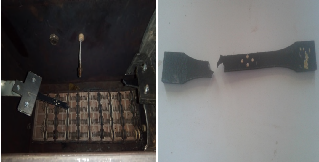
FIG IV.5: photo présentée la rupture de l'éprouvette du Mélange PA6 à charge de \sigma=9.2\text{Mpa} et T = 150\text{ }^\circ\text{C} .
