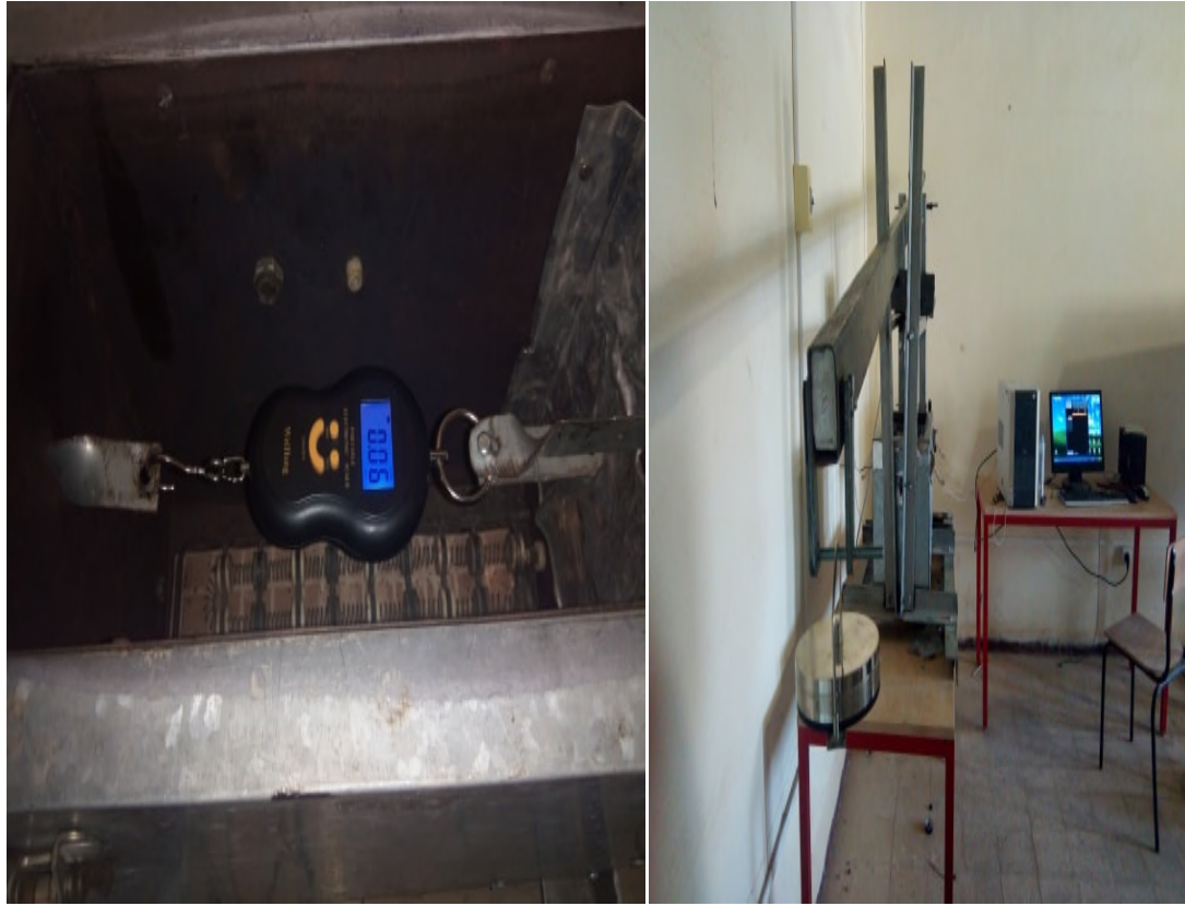
Figure III.9a : Montage d'étalonnage de l'appareil
