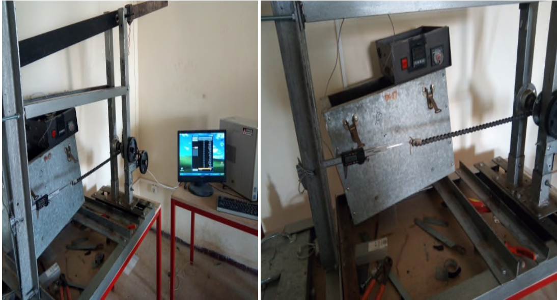
Figure III.8c: étalonnage du système d'acquisition par pied à coulisse
