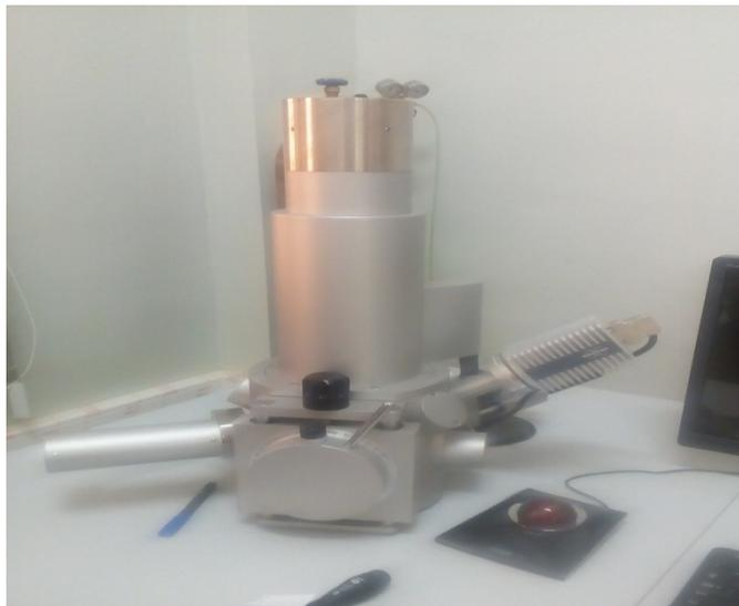
**Figure.III.12** : Microscope Electronique à Balayage de type **RIGAKU**.
