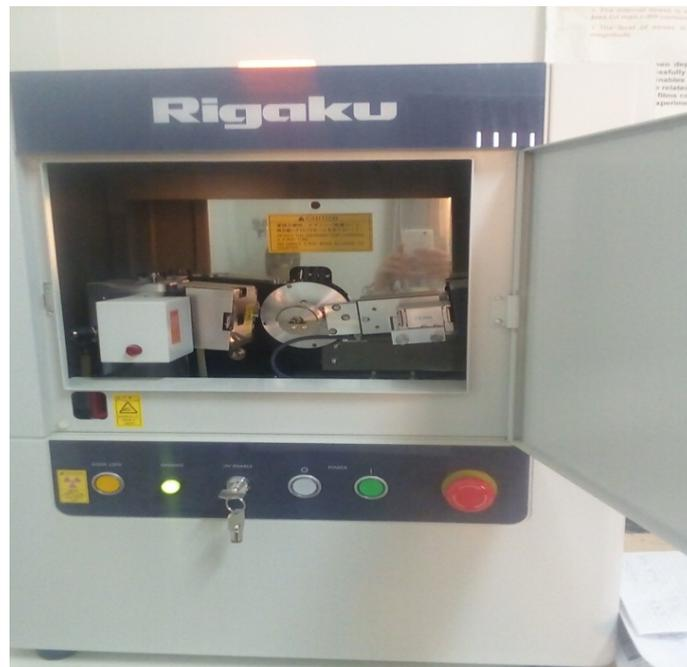
Figure.III.11. Le diffractomètre de rayons X de type \* **RIGAKU** \*.
