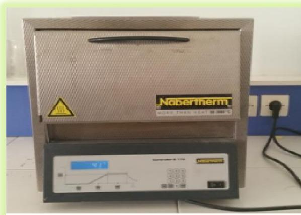
**Fig.III.2:**Four de Traitement Thermique Nabertherm
