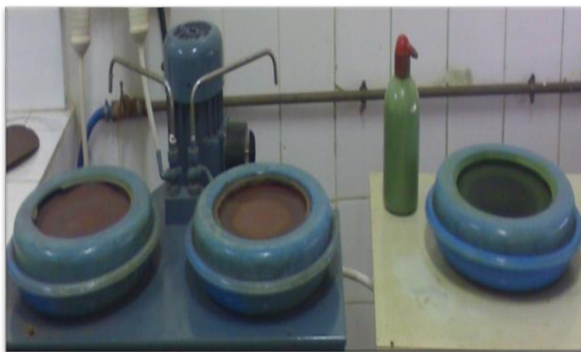
Figure .III.13 . Instruments de polissage mécanique
