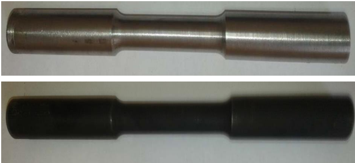
Figure III.8 : Eprouvettes cylindriques de traction avant et après la trempe
