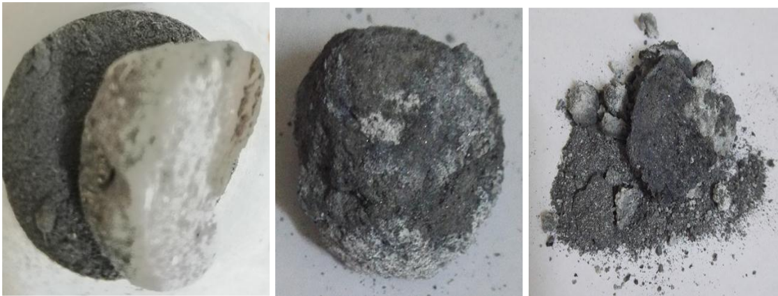
Figure II. 5: Résultat de la fusion à l'air libre de la poudre nettoyée pendant 20 minutes à 900 °C, pendant 1 heure à 1000 °C et 1100 °C respectivement
