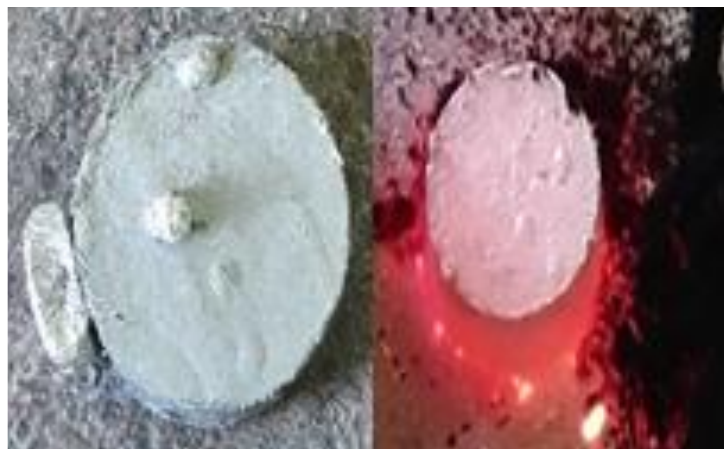
Figure II. 9: Résultat de la fusion au procédé de la poudre compactée réalisée à 1000 °C pendant 20 minutes
