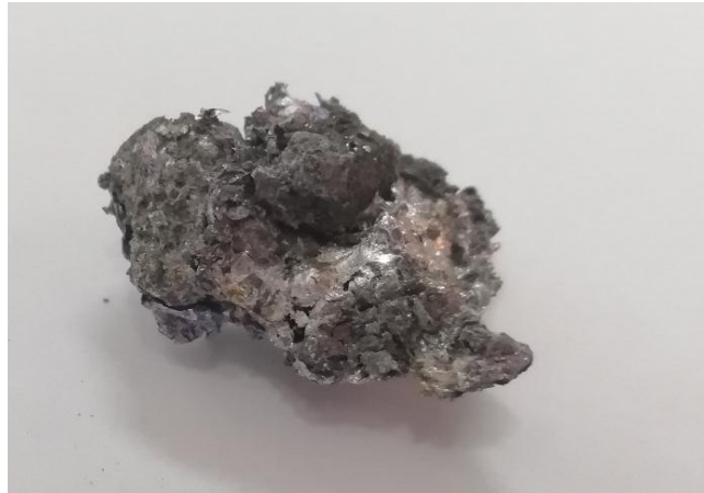
Figure II. 7: Résultat de la fusion au procédé de la poudre dans un bain fondu réalisée à 1100 °C pendant 1 heure
