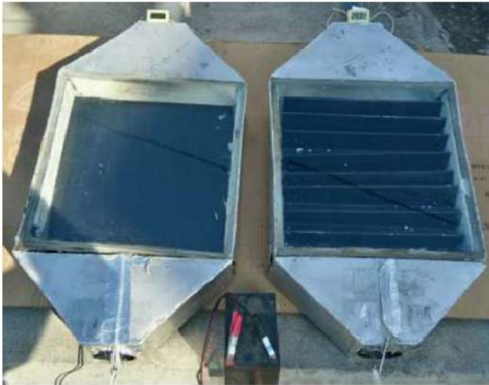
Figure 1.22 : Les deux capteurs solaires à air avec un lieu de mesure de la température [11]
