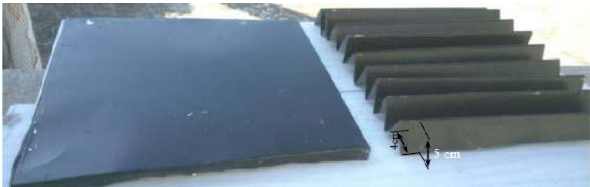
Figure 1.23 : La plaque absorbante plate et cassée e a la forme v [11]
