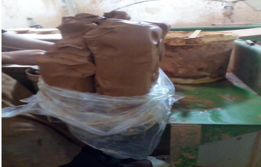
Fig.III.8 : Les cylindres de l'argile avant le formage.
