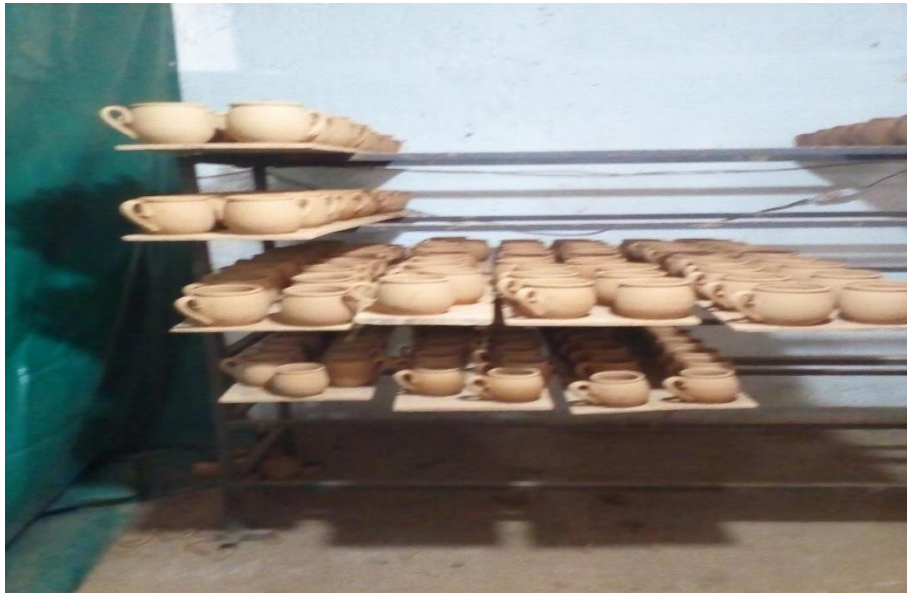
Fig.III.9 : Opération de séchage naturel du produit.
