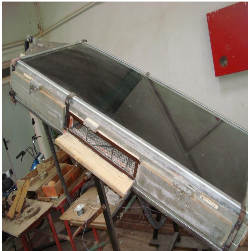
Fig.III.2 : Séchoir solaire utilisé dans la présente étude.
