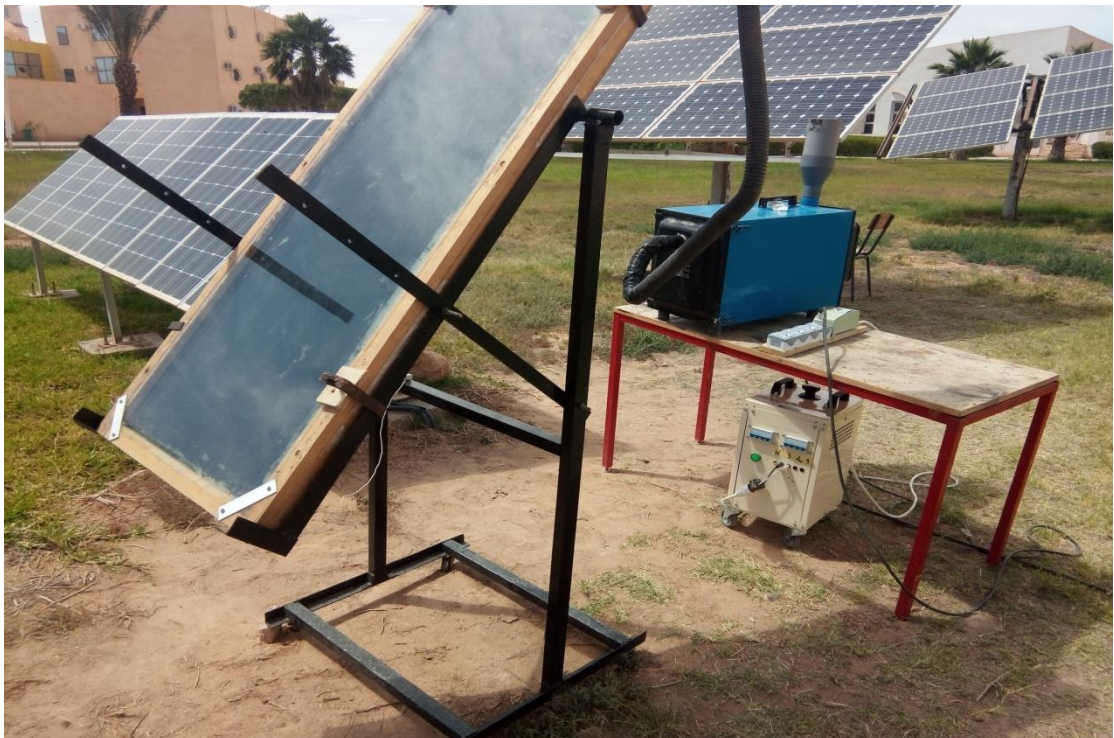
Figure.III.1: capteur solaire plan à air exposé au soleil en direction du Sud.
