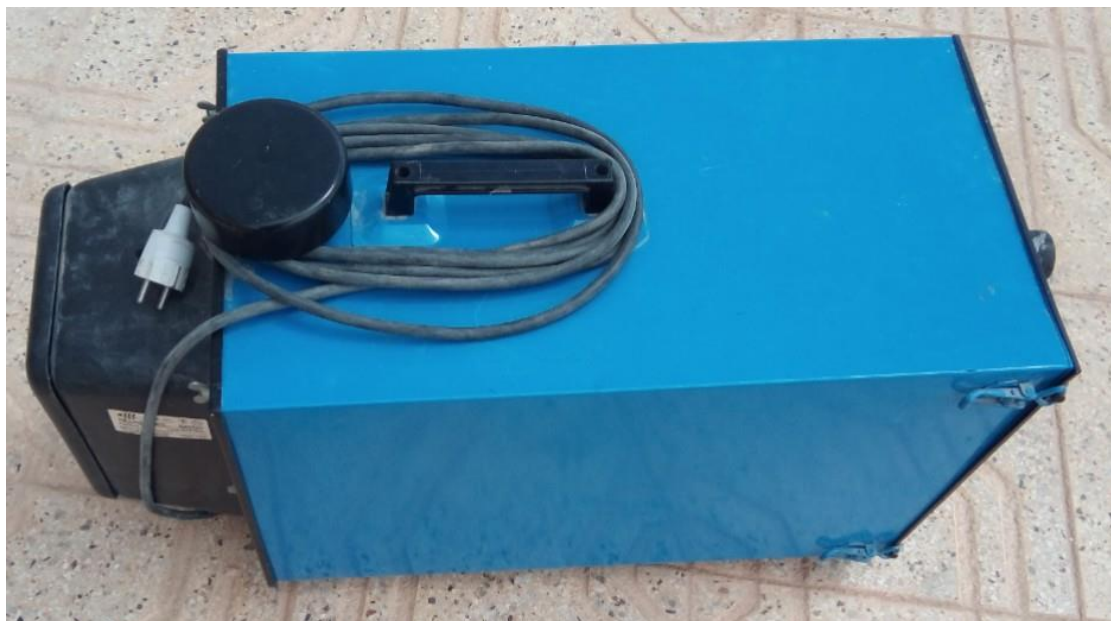
Figure.III.7. Aspirateur pour le pompage d'air (Type MPF.803, 1000W)
