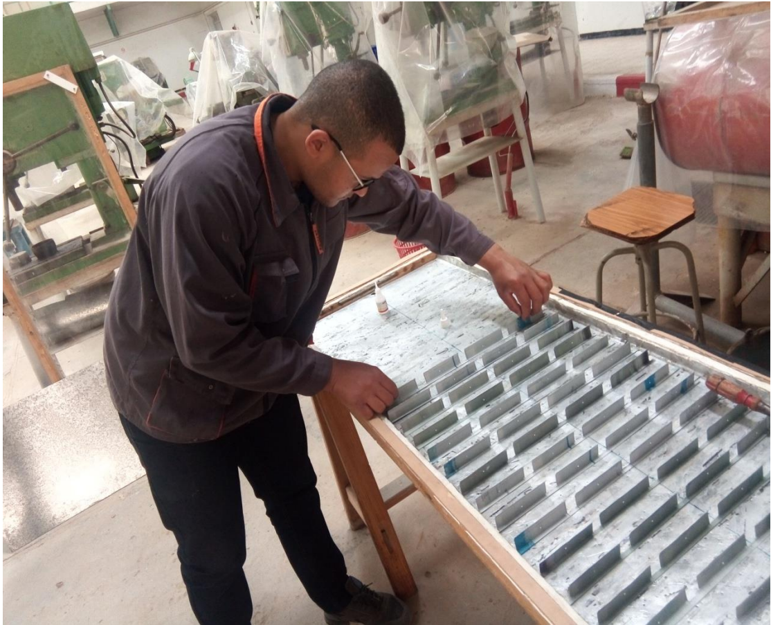
Figure.III.4: chicanes rectangulaire-rectangulaires en aluminium perforées au centre du rectangle bas disposées en rangées
