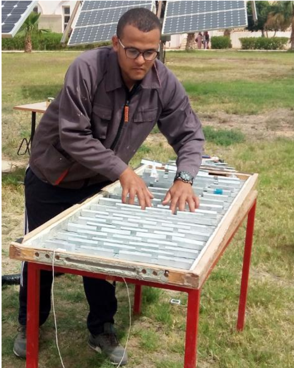
Figure.III.5: chicanes rectangulaire-rectangulaires en aluminium perforées au centre du rectangle bas en quinconces
