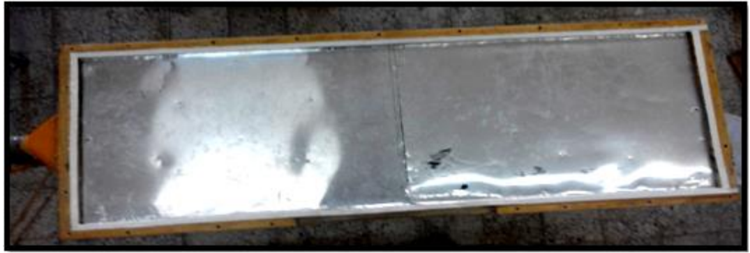
Figure.III.2: partie interne de l'isolateur couvert d'une feuille mince en aluminium
