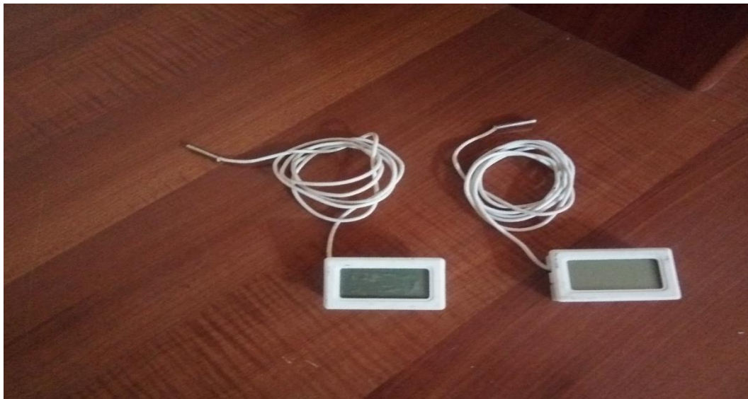
Figure.III.9. Thermocouples pour mesurer la température d'entrée et la température de sortie du panneau.
