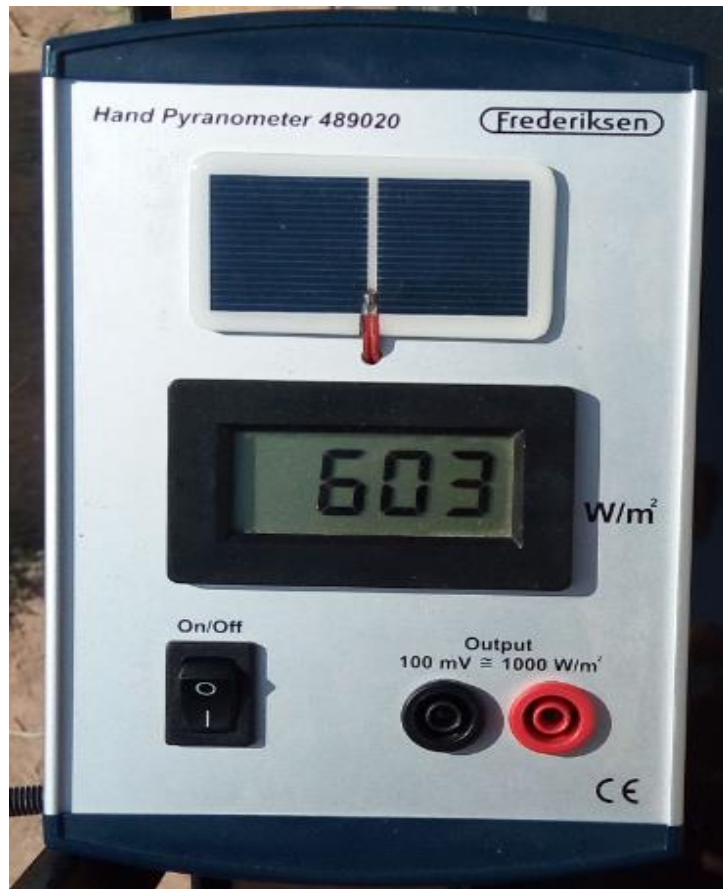
Figure.III.6. Pyranomètre manuel avec écran d'affichage à cristaux liquides pour mesurer le rayonnement solaire (Plage de mesure:0-1999W/m 2 .Résolution:0,1w/m 2 )
