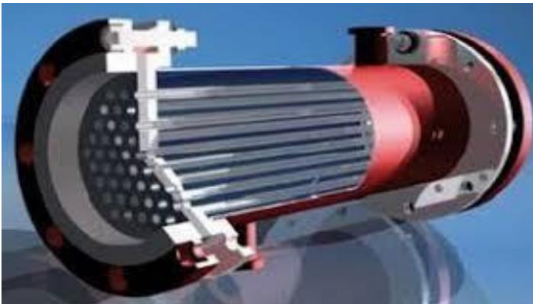
Figure I.7 : Echangeur à tubes et calandre [8].
