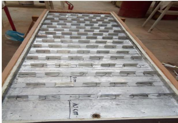
**Figure II.6 :** rugosité artificielle rectangulaire.
