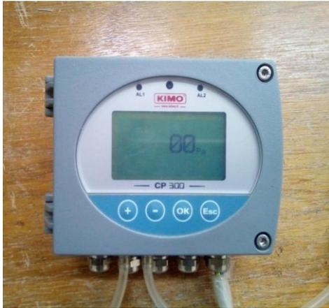
**Figure II.4 :** Capteur différentiel de pression.
