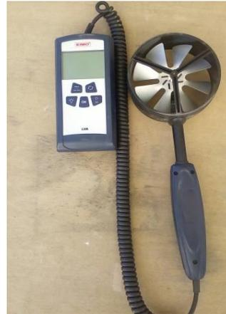
**Figure II.5 :** Anémomètre à hélice.
