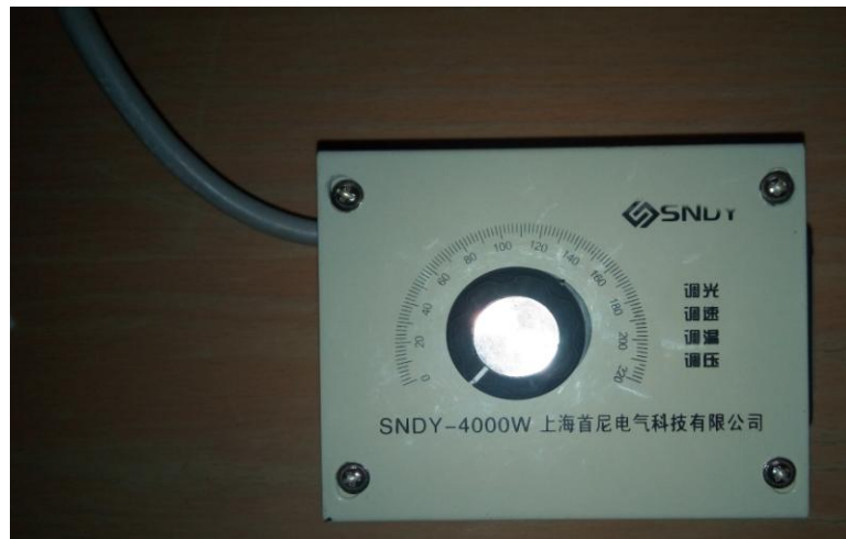
Figure III.17 : Régulateur de tension.
