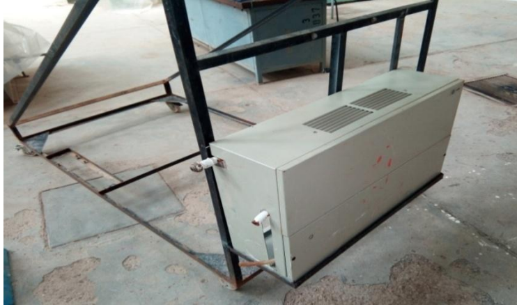
Figure III.8 : Support métallique de l'échangeur de chaleur fixé par soudage.
