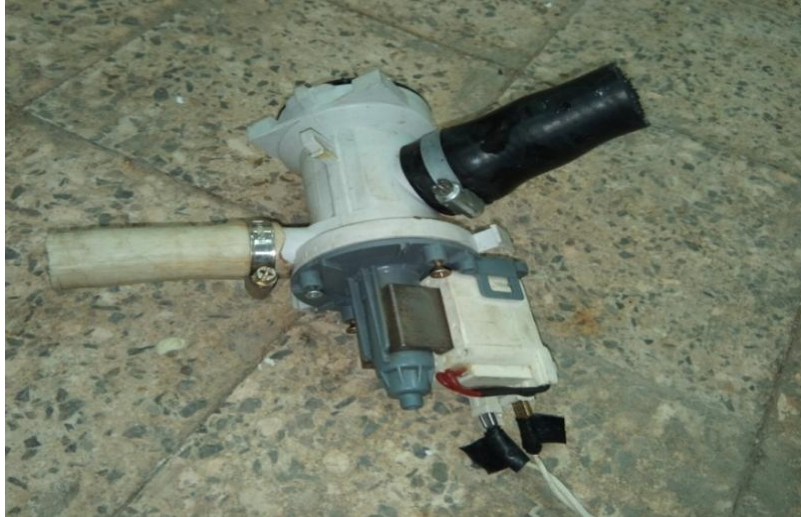
Figure III.10 : Pompe à eau.
