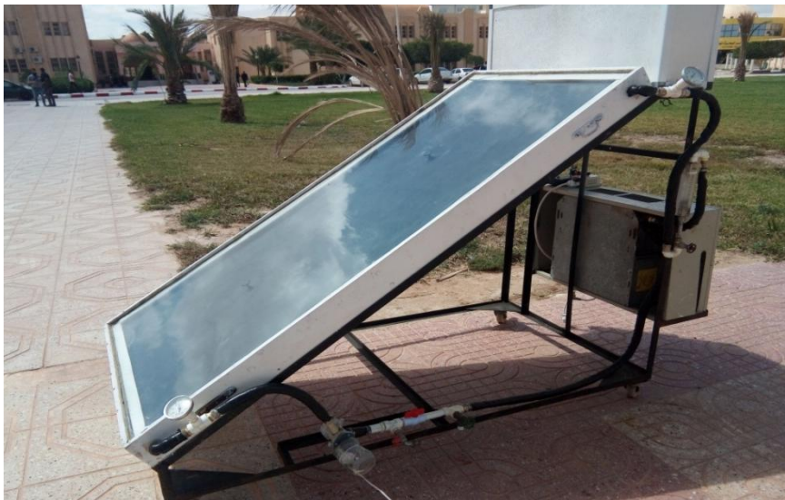
Figure III.2 : capteur solaire plan à eau exposé au rayonnement solaire Incident en direction plein sud.
