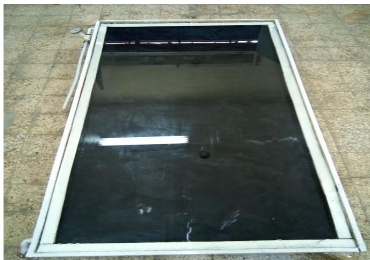
Figure III.6 : capteur solaire plan à eau avec couverture transparente en verre.
