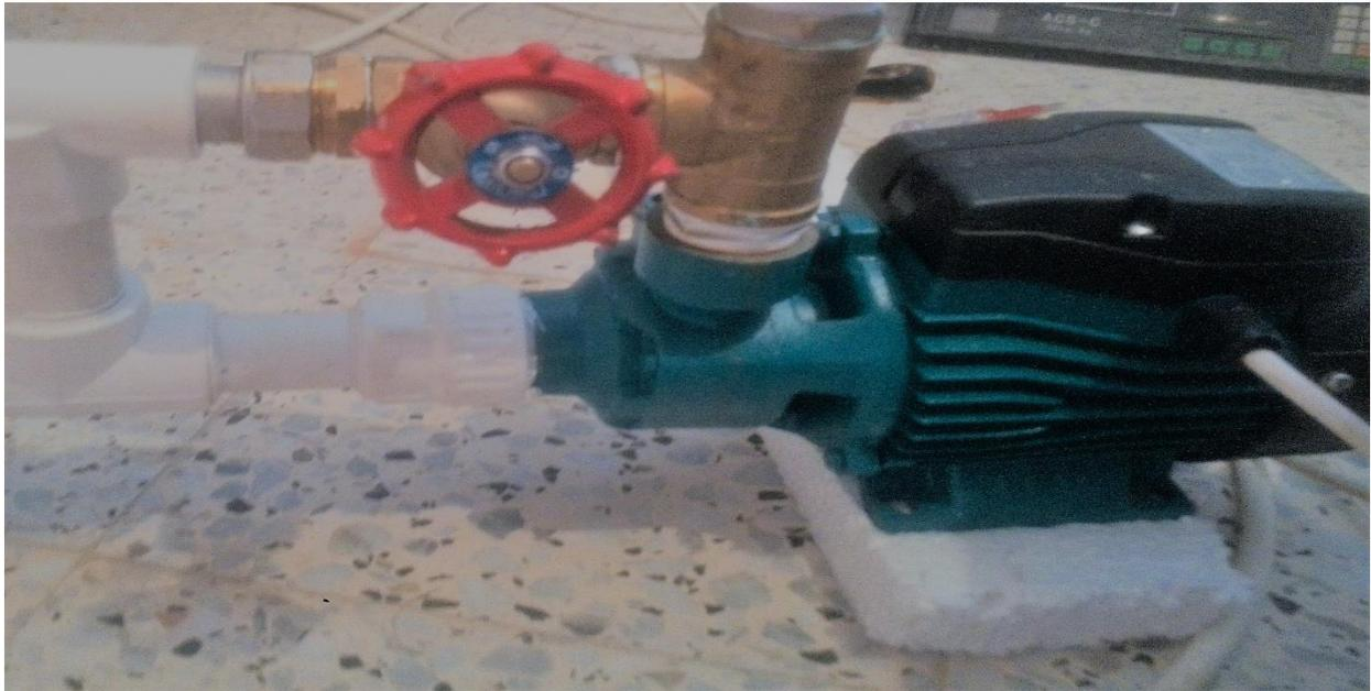
**Figure.3.12** une vanne pour contrôler le débit du circuit.
