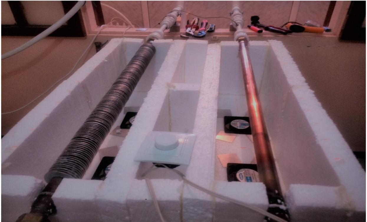
Figure.3.18 Installation des tubes avec les ventilateurs et le variateur .
