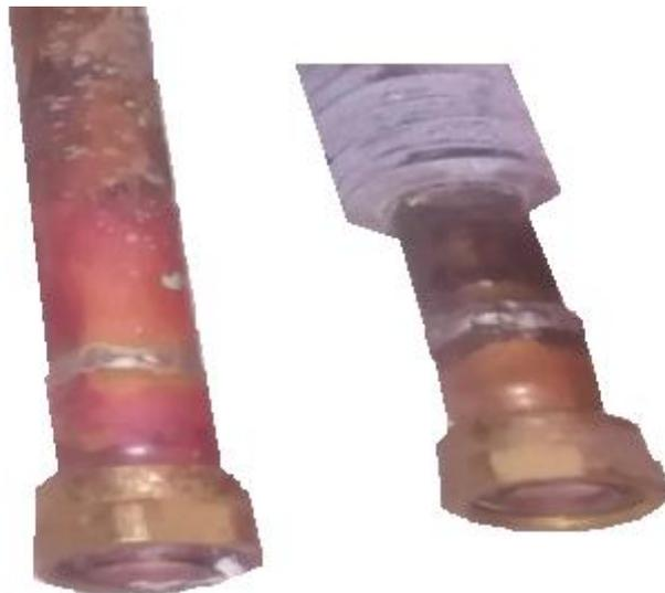
**Figure.3.9** Fixation du tube à l'écrou.
