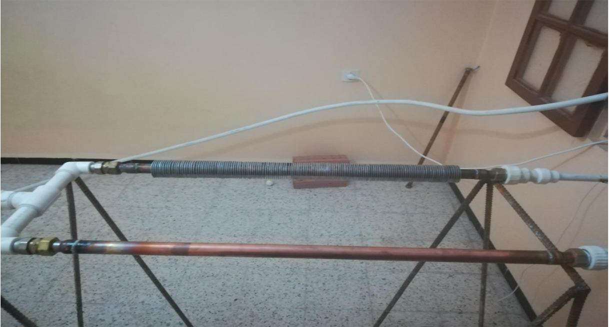
**Figure.3.10** installations des tubes dans le circuit.
