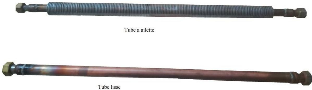
**Figure.3.2.** Tube à ailettes et tube lisse.
