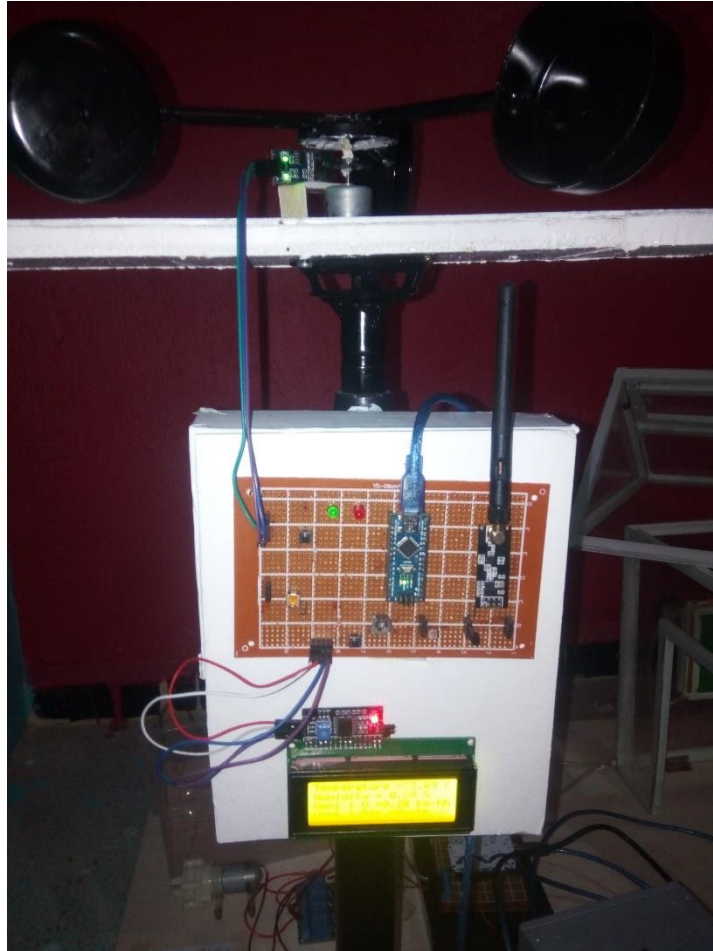
Figure II.15 : L'état final de notre Station météo.
