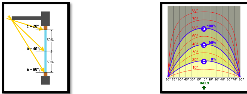
Figure 3-6 : Profil d'ombre d'un écran horizontal
