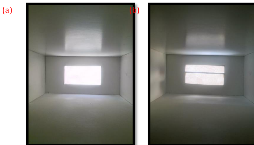
Figure5-4 : Modèles équipé par (a) un auvent unique horizontal et (b) un Light-Shelf (Source :auteur).
