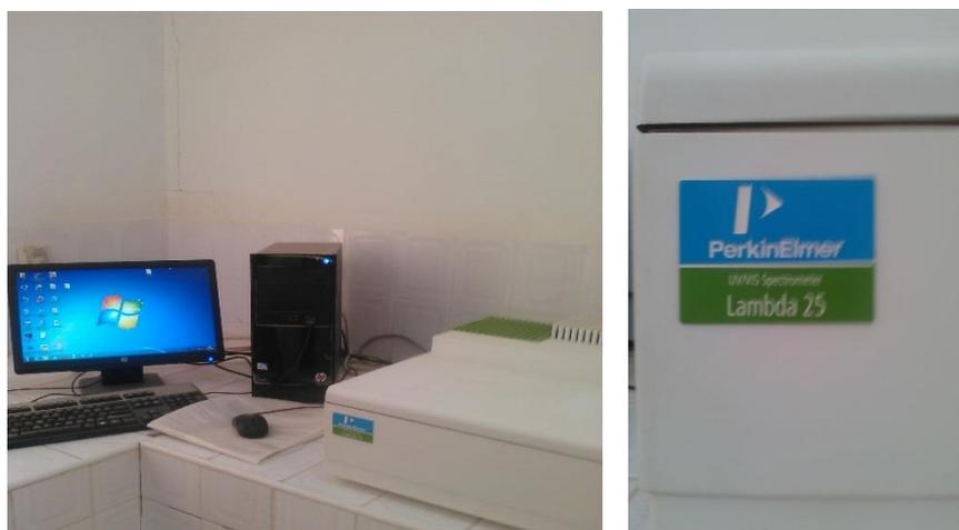
**Figure II-02:** Spectrophotométrie d'absorption moléculaire UV-visible.
