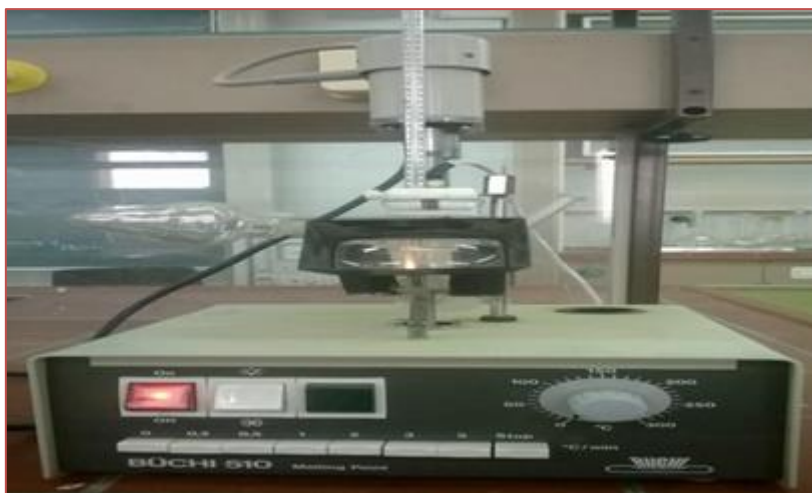
Figure (II.3) : Photographie de l'appareil de point de fusion utilisé.
