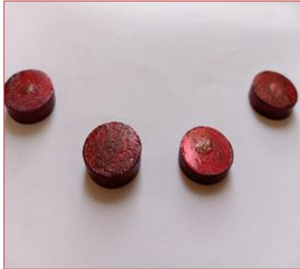
Figure (II.14) : L'apparence des échantillons X42 avec le revêtement.
