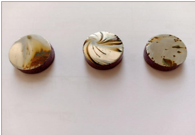
Figure (II.17) : L'apparence de l'échantillon après 3 heures d'immersion.
