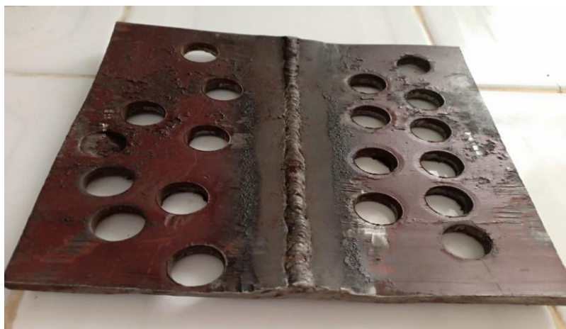
Figure (II.11) : l'apparence de tôle X42 après le découpage.
