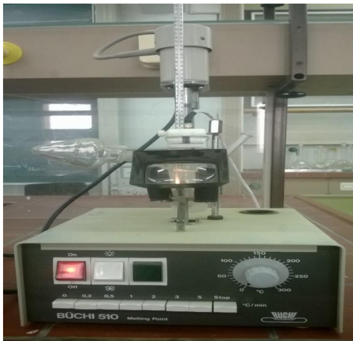
Figure (II.4) : Photographie de l'appareil de point de fusion utilisé.
