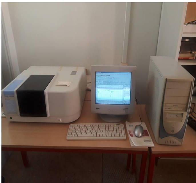
Figure (II.5) : Photographie de l'appareil d'IR utilisé.
