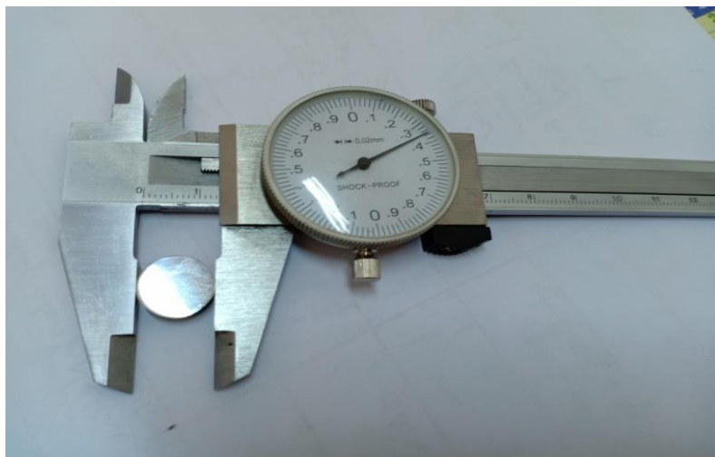
Figure (II.12) : Apparence de l'échantillon de métal X42 après la préparation.
