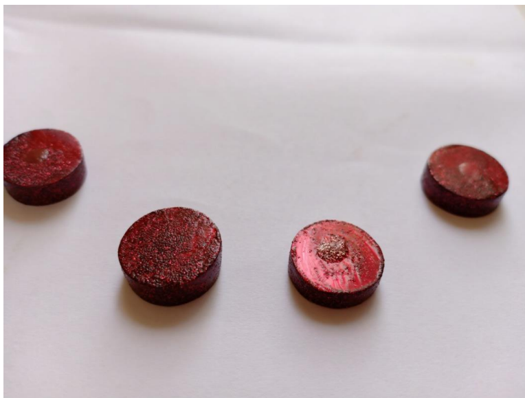
Figure (II.14) : L'apparence des échantillons X42 avec le revêtement.
