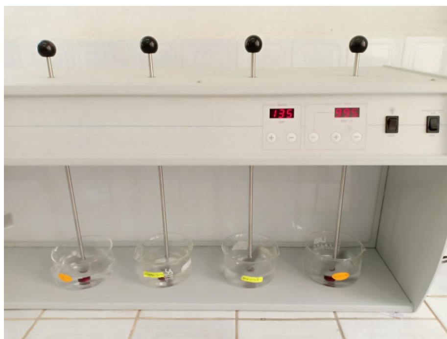
Figure (II.16) : L'apparence de l'expérience d'immersion dans les premiers heures d'agitation.
