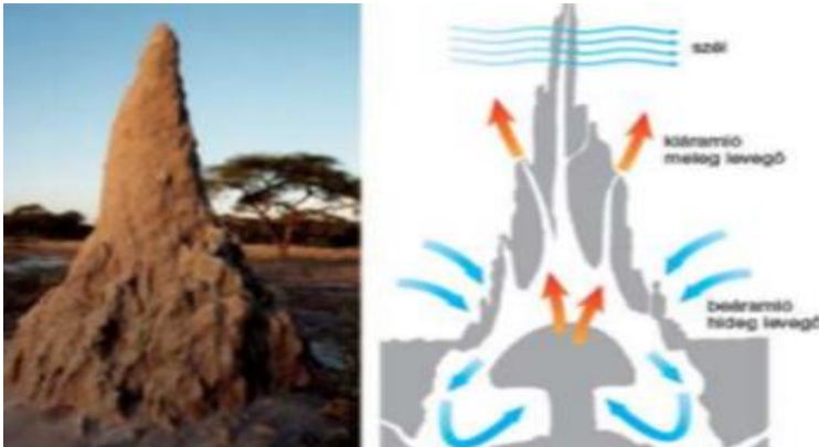
Figure 41 : East gate Center – Imitation du système de ventilation d'une termitière tiré de El DIN & al., 2016, p.381
