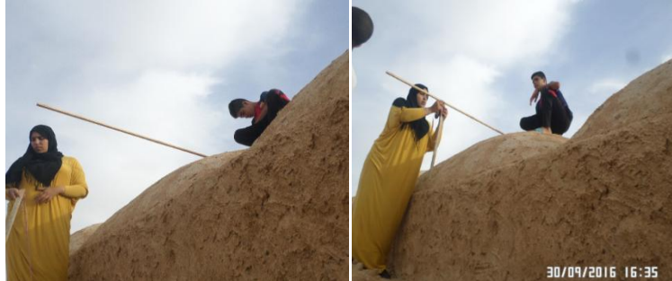
FIG (III-04) : la méthode du relevé des coupoles (Source : Auteur / 2017)
