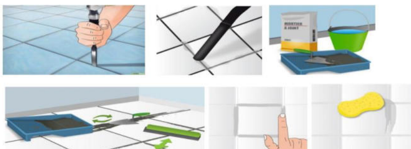
Figure160. étapes de faire le carrelage Source : carrelage.ooreka.fr
