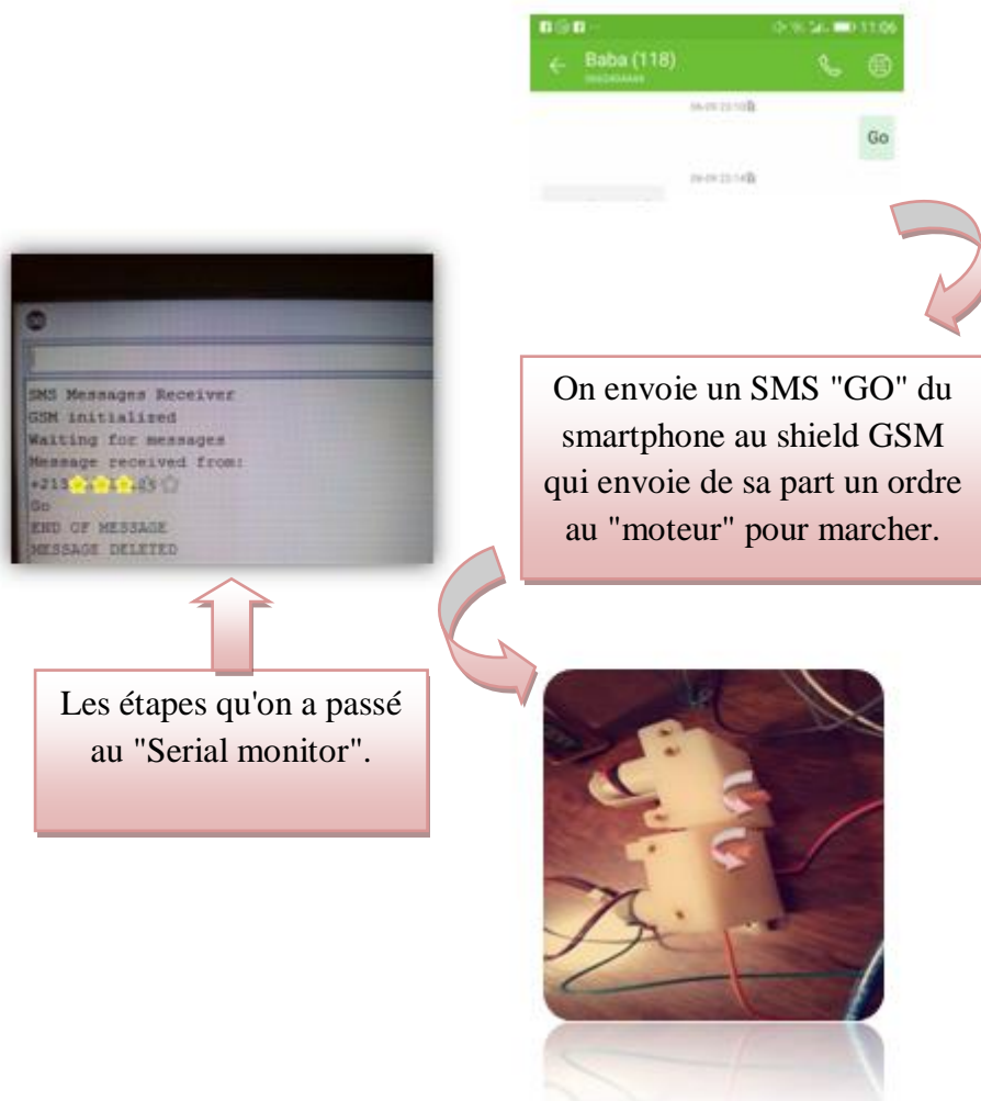
Figure III.9 -Test de rotation de deux petits moteurs à DC.
