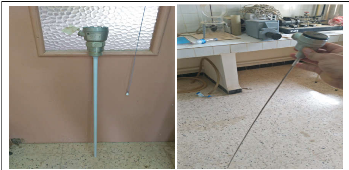
Figure 3.5 : Capteur de niveau analogique piézo-résistif. .
