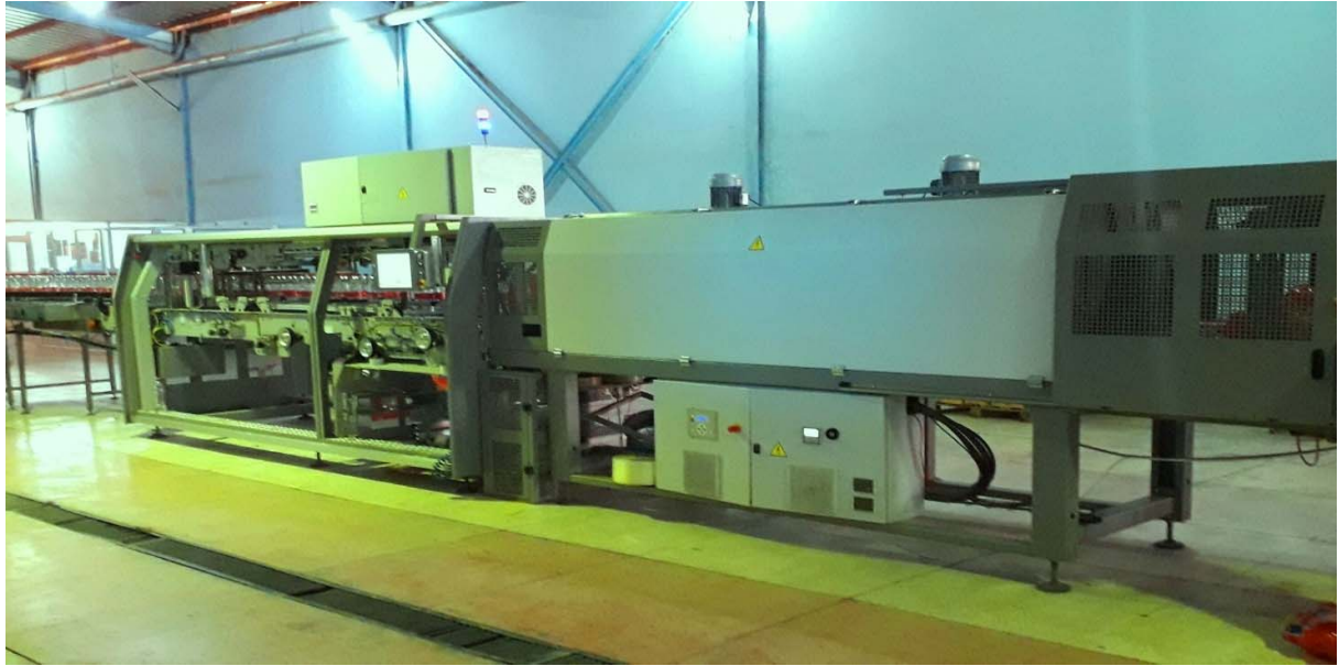
Figure I.16 : Fardeleuse de bouteilles PET
