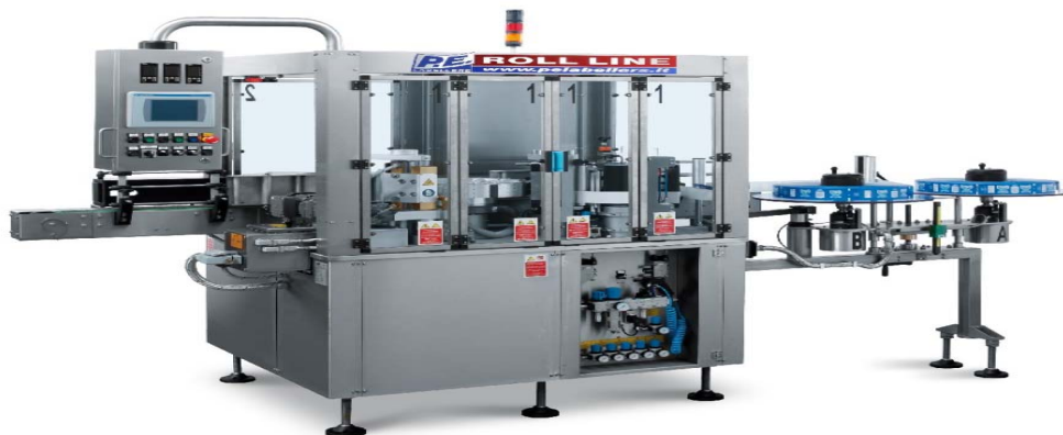
Figure I.14 : Etiqueteuse de bouteille.
