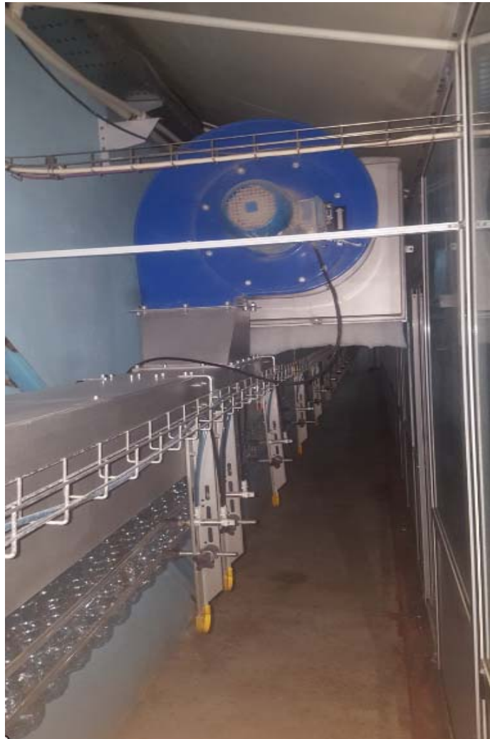
Figure I.10 : Convoyeur aérien de bouteilles
