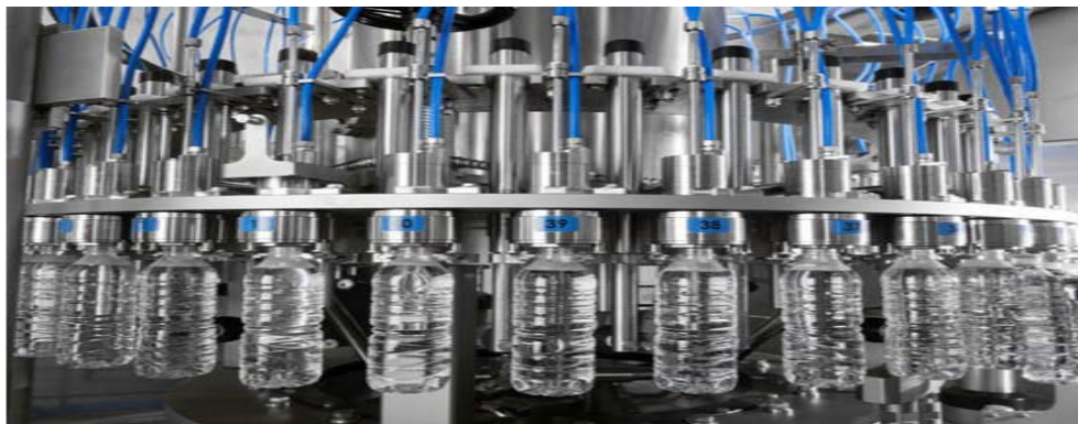
Figure I.12 : Remplisseuse de bouteilles
