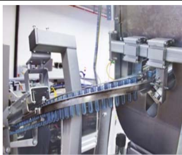
Figure I.4 : Alimentation des préformes
