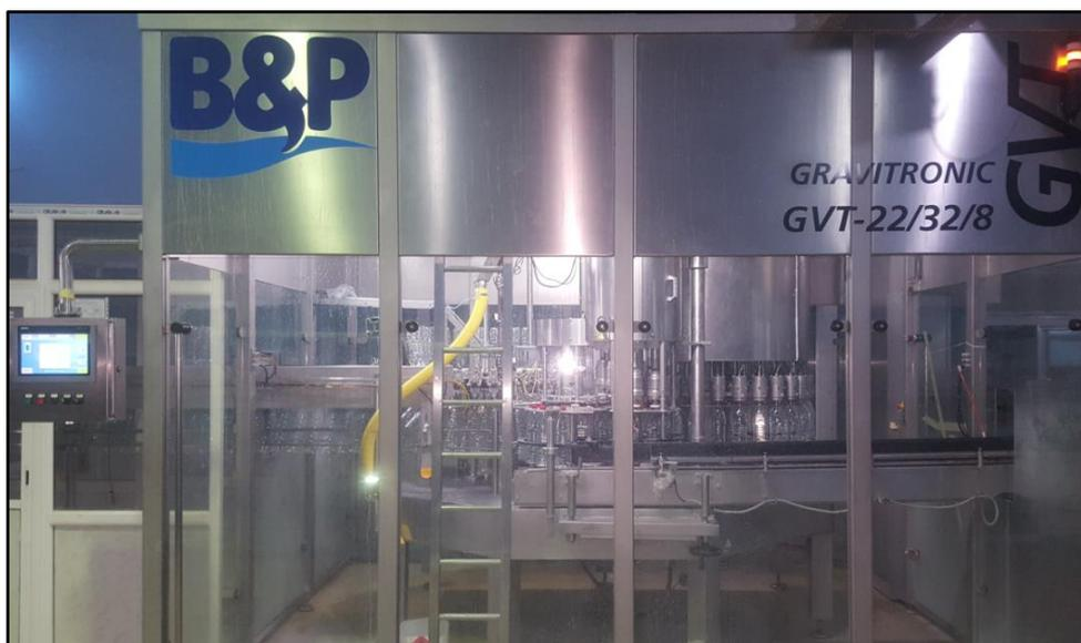
**Fig I.11** : Machine soutireuse
