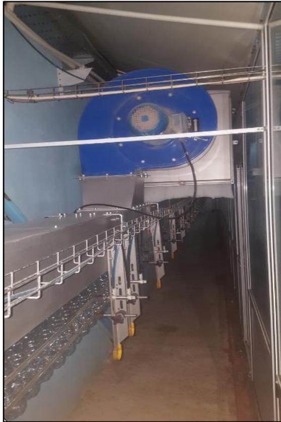
**Fig I.10** : Convoyeur aérien de bouteilles.
