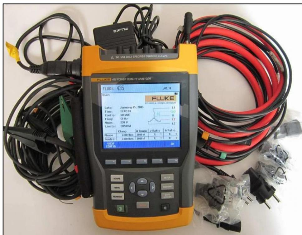
**Fig IV.13** : Analyseur de réseau « FLUKE 435 série II »
