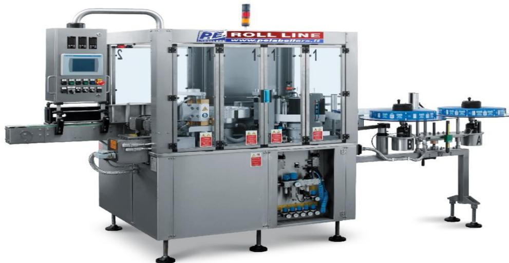
**Fig I.14 :** Etiqueteuse de bouteille.
