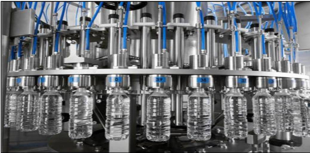
**Fig I.12 :** Remplisseuse de bouteilles.
