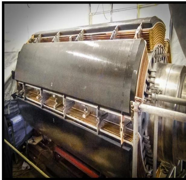
**Fig III.5** : Compensateur synchrone statique
