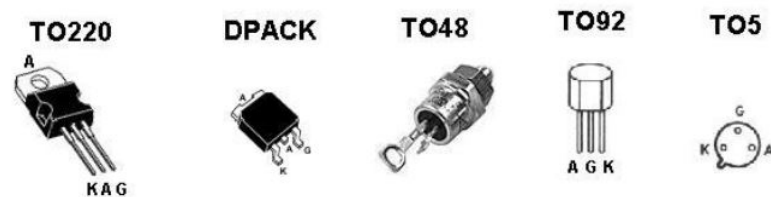
Fig 2.9: différents type de thyristor.
