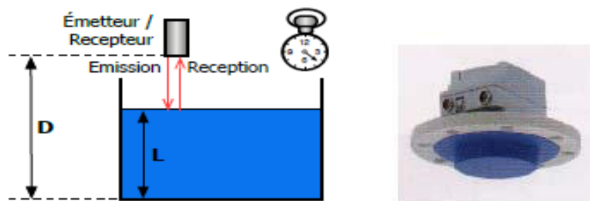
Figure 2.6 : Principe de mesure par ondes et Capteur de niveau acoustique
