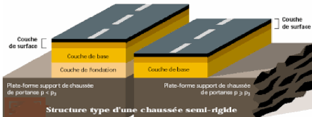
Figure IV.3 : structure type d'une chaussée semi-rigide
