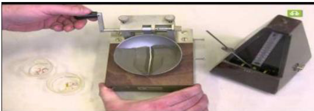
Figure II.1 : Détermination de la limite d'Alterberg.
