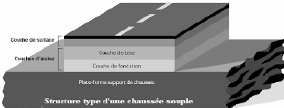
Figure IV.2 : structure type d'une chaussée souple
