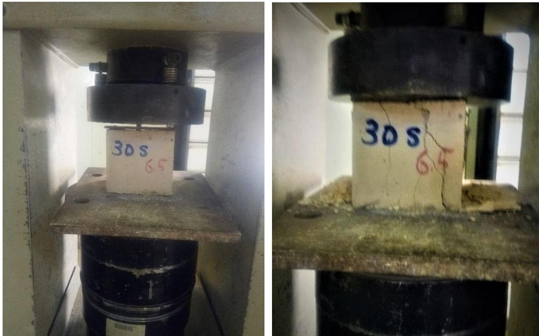
**Figure 2.17** : Essai d'écrasement de les éprouvettes cubique.
