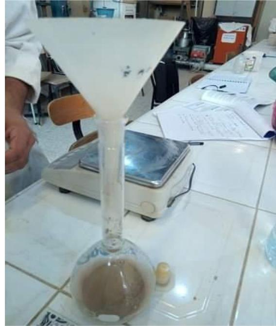
**Figure 2.3** : Appareillage de mesure de la masse volumique absolue.
