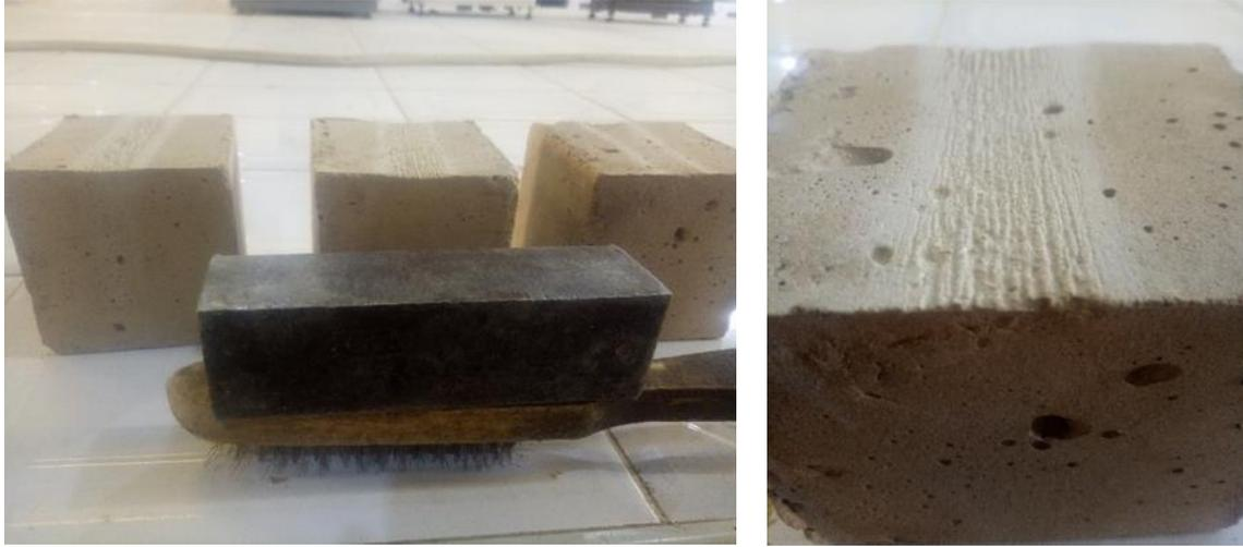
**Figure 2.24** : Essai de résistance à l'abrasion.
