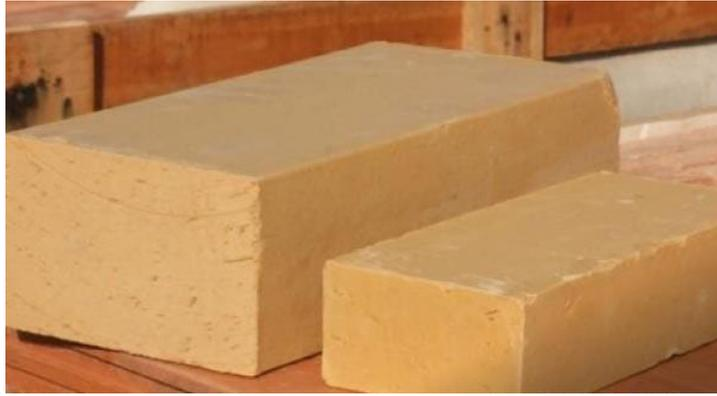
**Figure 1.4:** Exemple de brique de terre compressée de différentes tailles.
