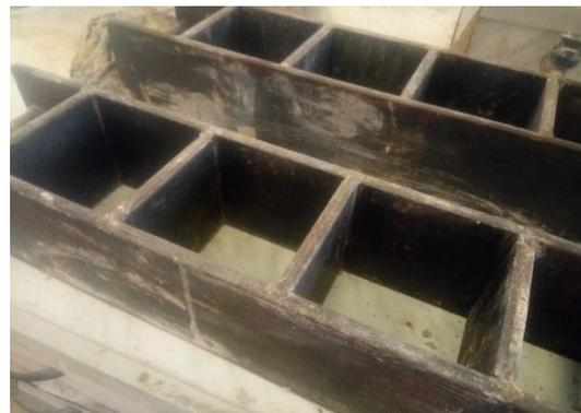
**Figure 2.12** : Le moule utilisé pour le moulage et la confection des briques
