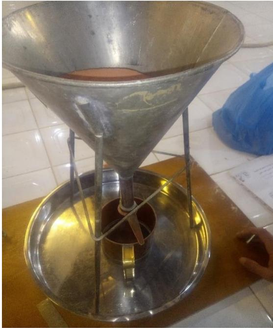
**Figure 2.2** : Appareillage de mesure de la masse volumique apparente.
