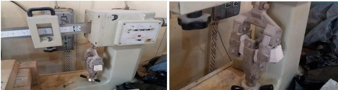
Figure 2.19 : L'essai de résistance à la flexion.
