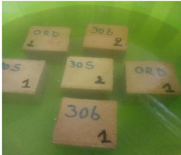
**Figure 2.23 :** Immersion totale des blocs.
