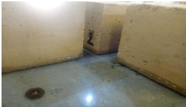
**Figure 2.22** : Essai d'absorption capillaire d'eau
