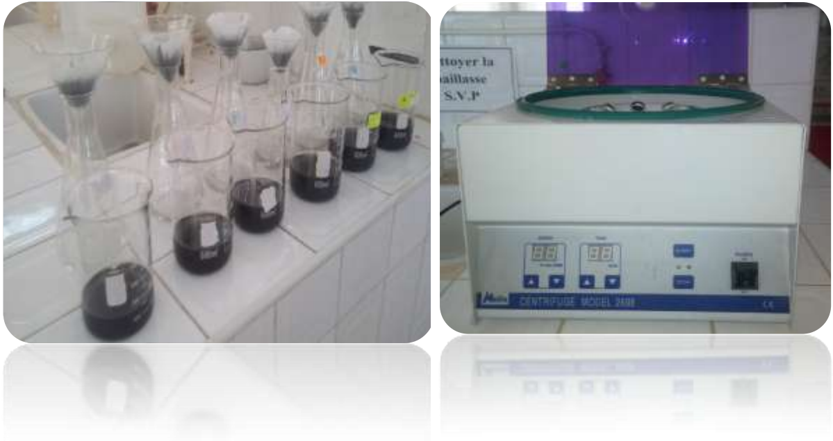
Figure IV.2 : Le procédé de séparation solide-liquide : (a) : filtration ; (b) : centrifugation
