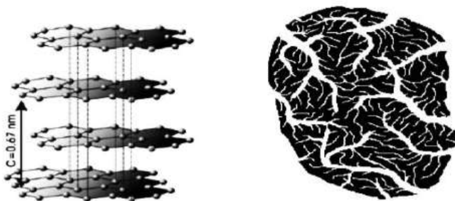
Figure II.3 : Structure chimique du charbon actif et représentation schématique de sa structure [40]
