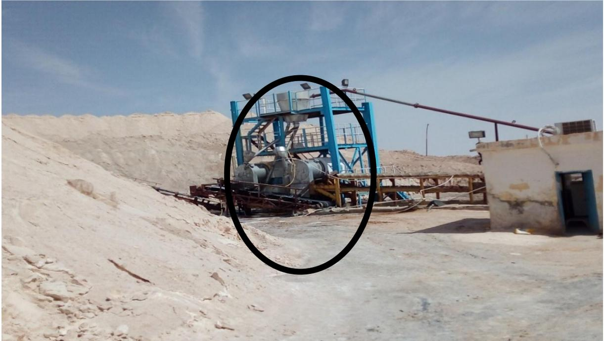
**Figure III.3 :** l'hydrocyclone et l'essoreuse
