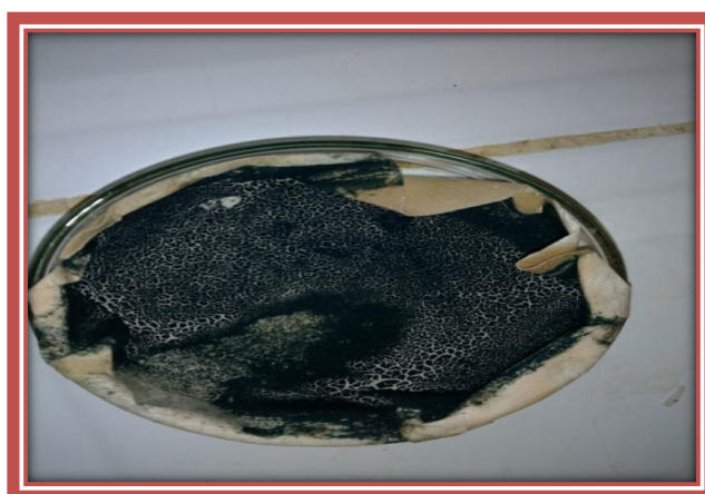
Figure IV. 8 : Polyaniline après le séchage.
