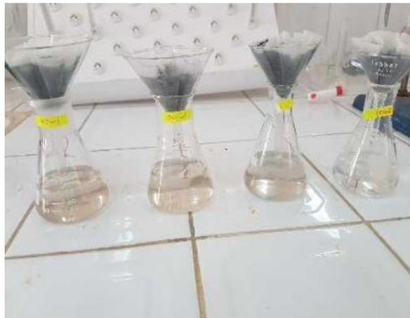
**Figure III.9 :** Procédé de séparation solide-liquide : (filtration)
