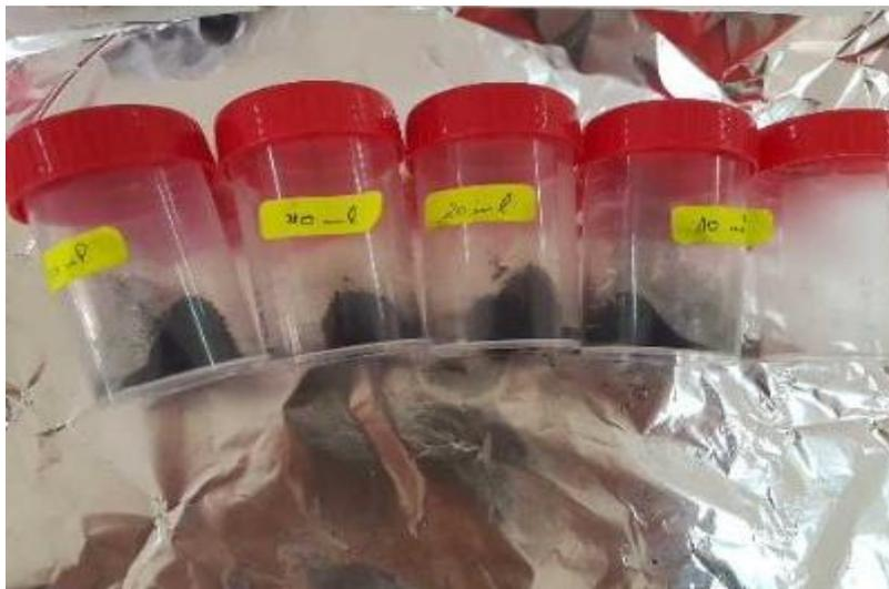
**Figure III.4 :** Les échantillons de charbon actif fabriqué.
